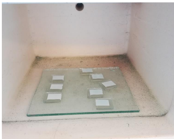
Slika 29. Pečenje oksidnog sloja
