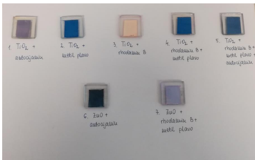
Slika 31. Osušena stakalca s oksidnim slojem i nanesenim bojom
