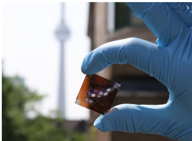
Slika 9. QD solarna ćelija 16
