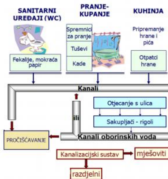
Slika 1.3. Izvori onečišćenja sanitarnom vodom 15
