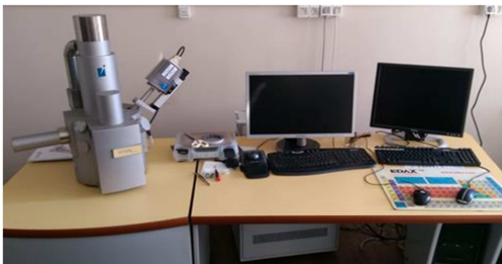
Slika 14. Pretražni elektronski mikroskop TESCAN VEGA 5136LS
