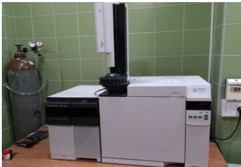
Slika 9. Vezani sustav plinska kromatografija – spektrometrija masa; Agilent Technologies 7820A/5977E
