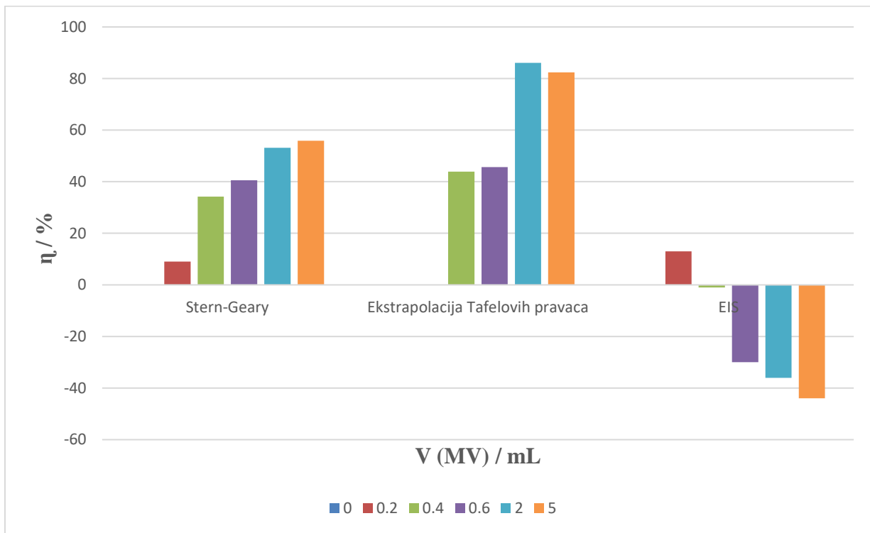
Slika 4.2. Usporedba djelotvornosti inhibicije korozije kositra uz i bez dodatka otopine meda u 3 % - tnoj otopini NaCl, pH = 3.0 određene iz polarizacijskog otpora u uskom području potencijala, ekstrapolacijom Tafelovih pravaca i elektrokemijskom impedancijskom spektroskopijom.
