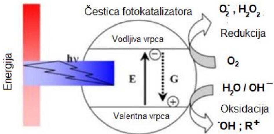
Slika 2. Mehanizam fotoaktivacije poluvodičkog katalizatora<sup>11</sup>
