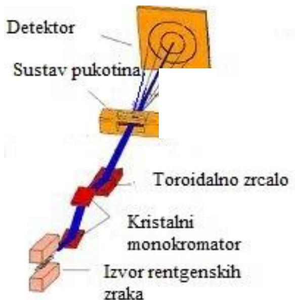
Slika 6. Shematski prikaz kamere za kolimaciju snopa X-zraka<sup>32</sup>
