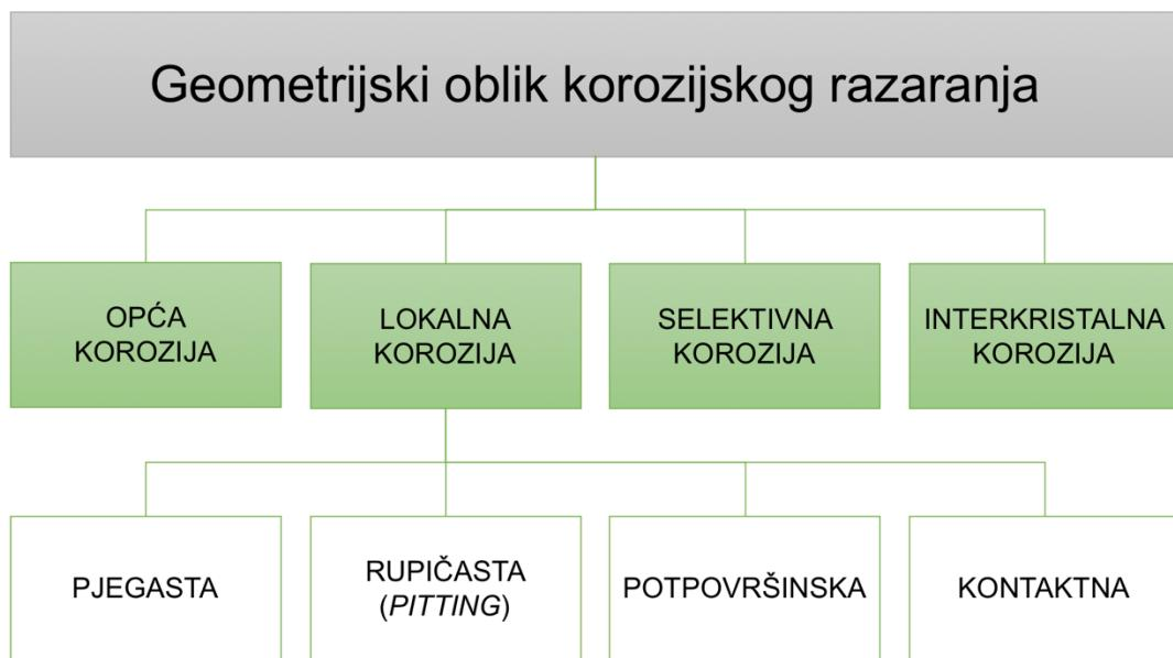
Slika 6. Klasifikacija korozije prema geometrijskom obliku koroziskog razaranja.
