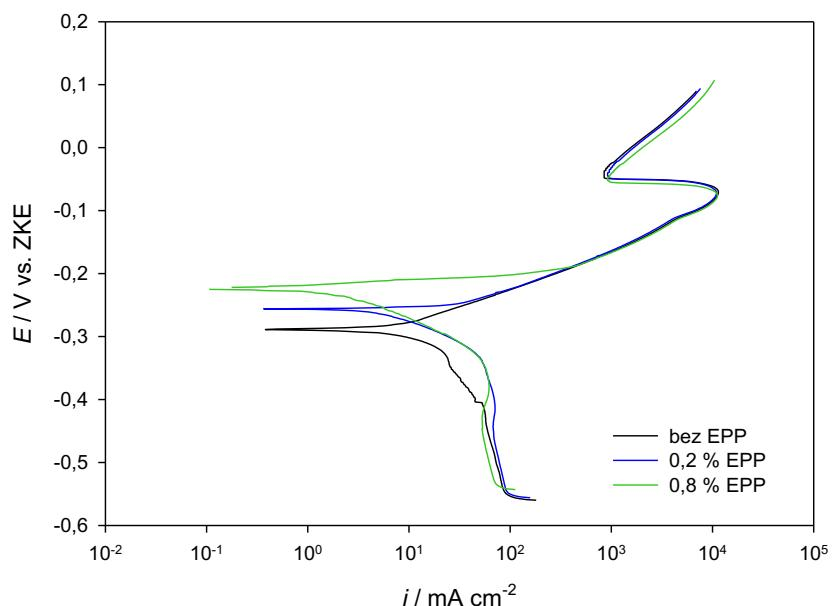
Slika 41. Anodne i katodne krivulje polarizacije bakra u  $0,5 \text{ mol dm}^{-3}$  otopini NaCl bez i uz dodatak ekstrakata *P. pavonica* u različitim koncentracijama pri  $30^\circ\text{C}$ .
