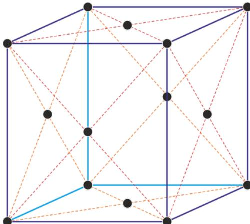
Slika 2. Kristalna struktura austenitnog čelika.<sup>20</sup>
