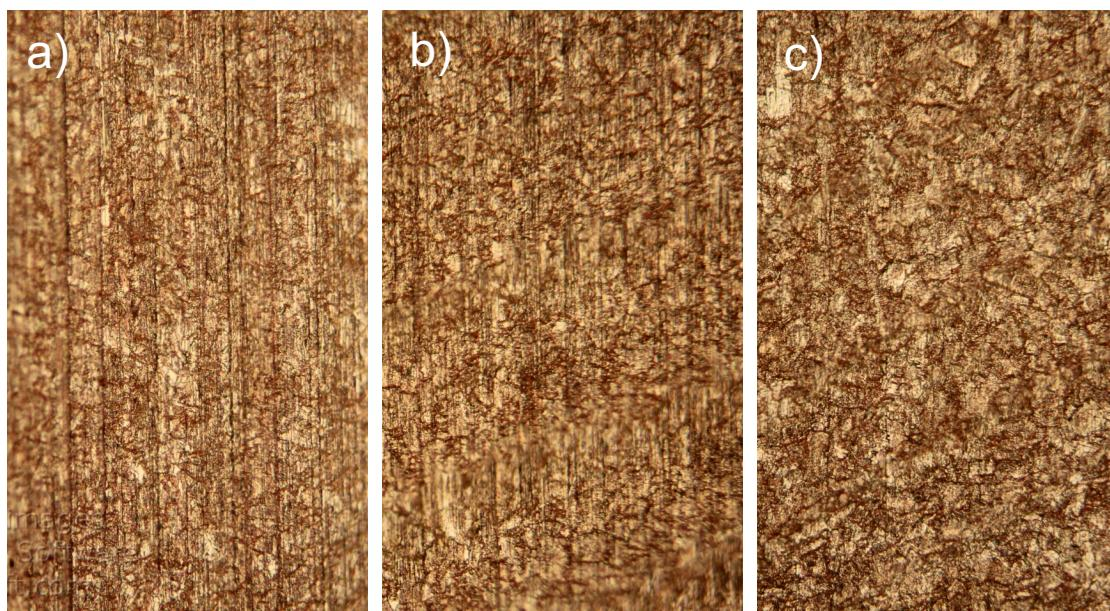
Slika 44. Fotografije površine bakra nakon potenciodinamičkog polarizacijskog mjerenja u  $0,5 \text{ mol dm}^{-3}$  otopini NaCl a) bez i uz dodatak vodenog ekstrakata *P.pavonica* b) 0,2 % i c) 0,8 % pri uvećanju od 200 puta.
