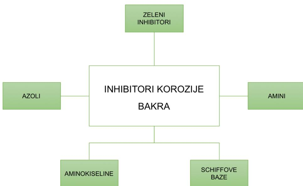
Slika 12. Najčešći inhibitori korozije bakra.
