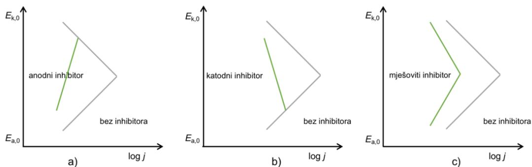
*Slika 11. Djelovanje inhibitora korozije: a) anodnog, b) katodnog i
