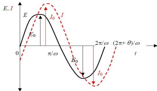
**Slika 1.15.** Narinuti potencijal i odziv struje u ovisnosti o vremenu u *ac* teoriji (kod  $f \neq 0$ )
