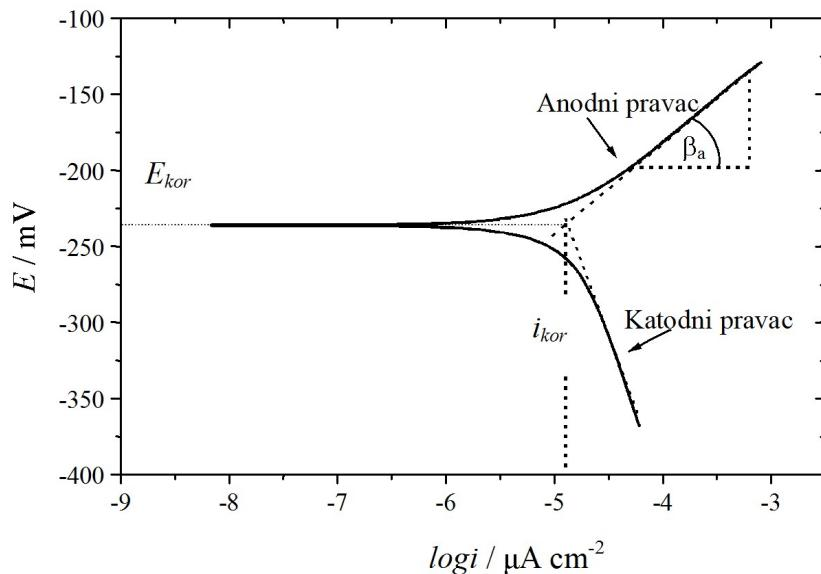
Slika 1.12. Tafelova metoda određivanja korozijskih parametara iz polarizacijskih mjerena<sup>27</sup>
