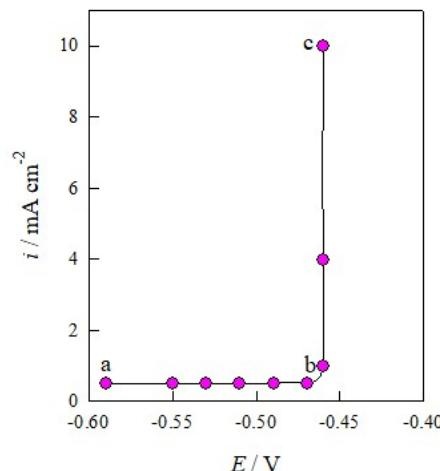
Slika 1.8. Stacionarna polarizacijska krivulja anodnog otapanja aluminija u 0.5 M NaCl<sup>22</sup>
