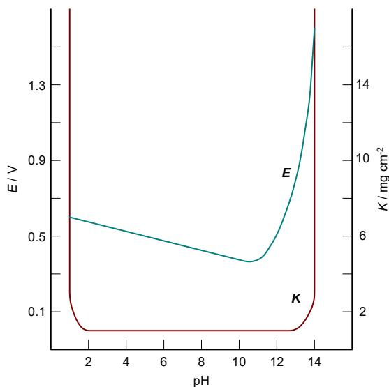
Slika 1.5. Ovisnost brzine korozije aluminija (K) i stacionarnog potencijala (E) o pH otopine<sup>13</sup>
