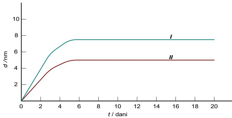
Slika 1.6. Brzina rasta oksidnog filma na poliranom aluminiju u kontaktu sa zrakom; krivulja I – aluminij čistoće 99.60 %, krivulja II - aluminij čistoće 99.98 %<sup>19</sup>
