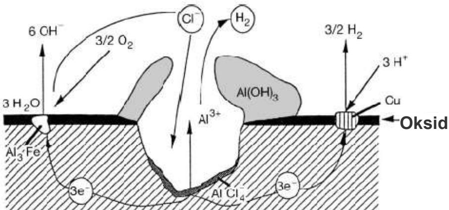
**Slika 1.9.** Mehanizam rupičaste korozije aluminija<sup>8</sup>
