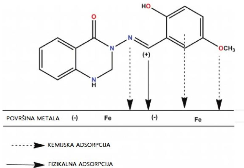
Slika 1.10. Mehanizam adsorpcije organskog inhibitora na površini metala
