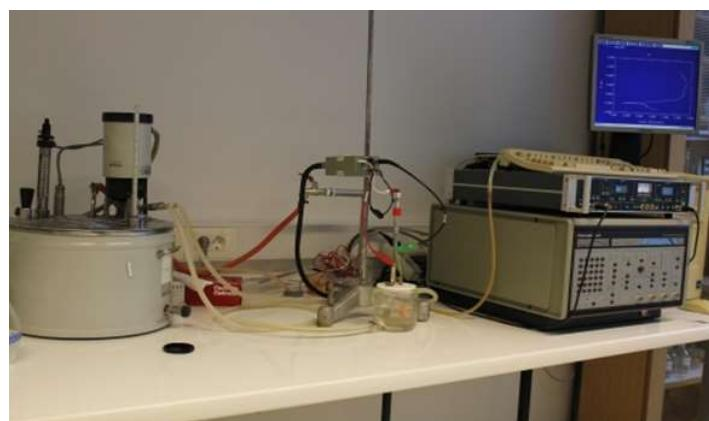
Slika 2.1. Aparatura za provedbu elektrokemijskih mjerena
