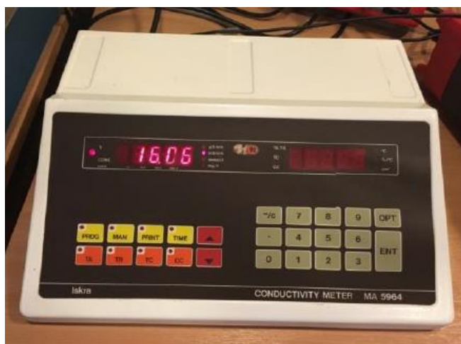
Slika 11. Konduktometar ISKRA MA 5964
