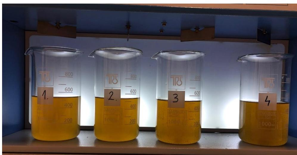
Slika 2.11. Proces flokulacije u JAR uređaju
