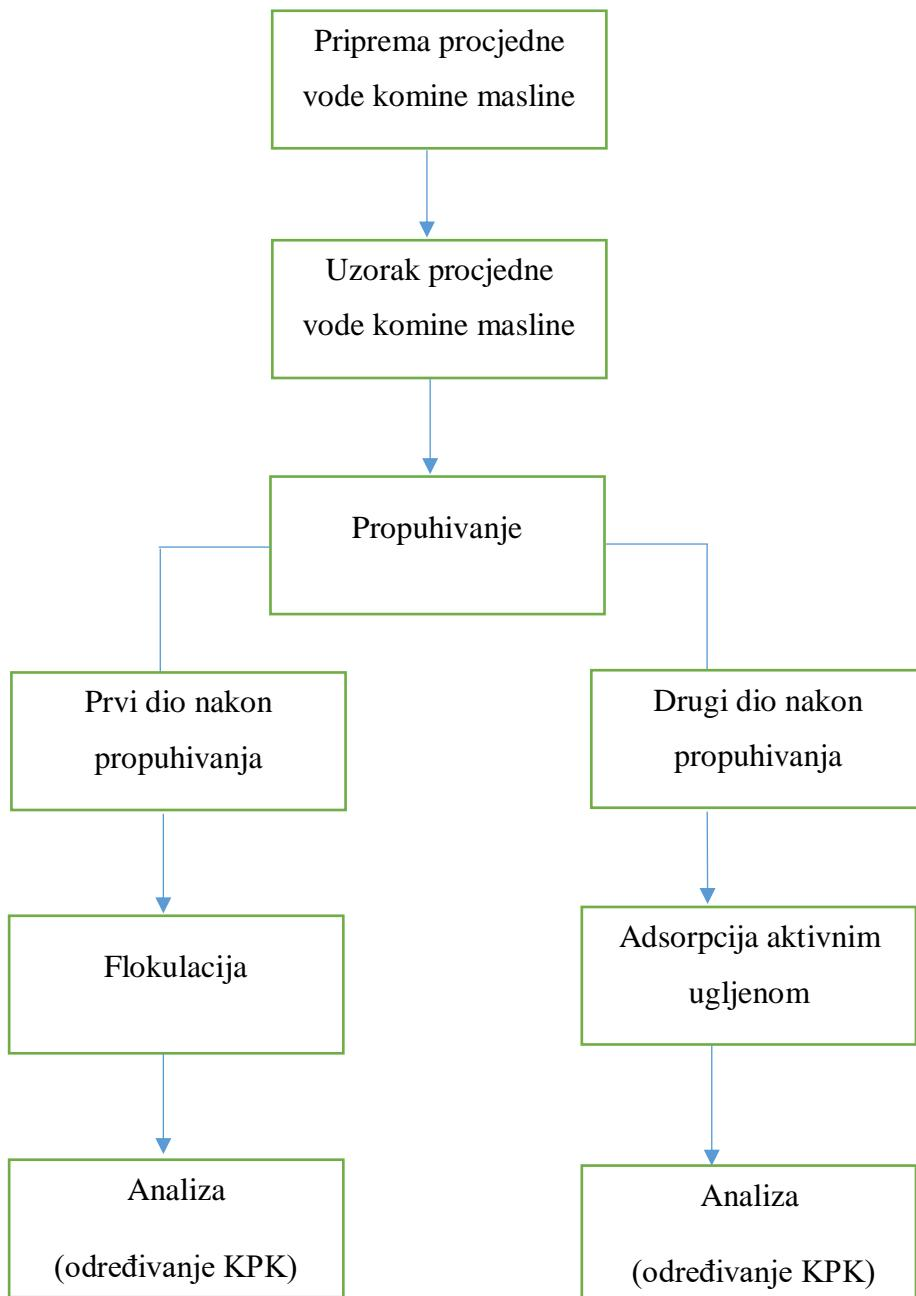
Slika 2.9. Shema provedenog eksperimenta obrade procjedne vode komine masline
