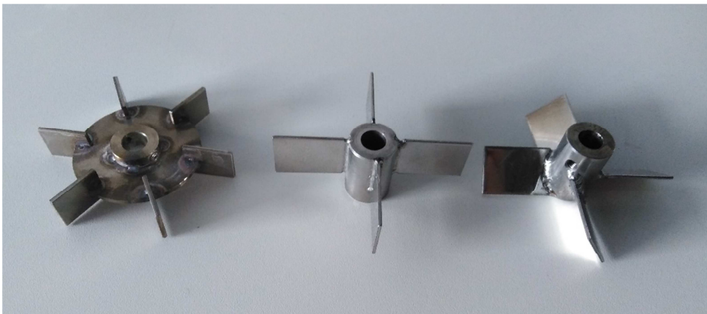
Slika 16. Turbinska miješala: RT, SBT, PBT
