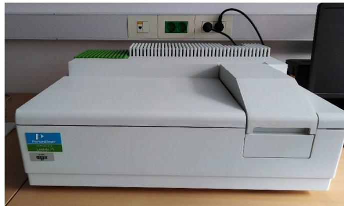
*Slika 14. Spektrofotometar*
