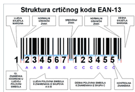
Slika 4. Struktura EAN 13 koda 1
