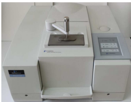
Slika 14. FT-IR spektrometar s dodatkom za snimanje HATR tehnikom
