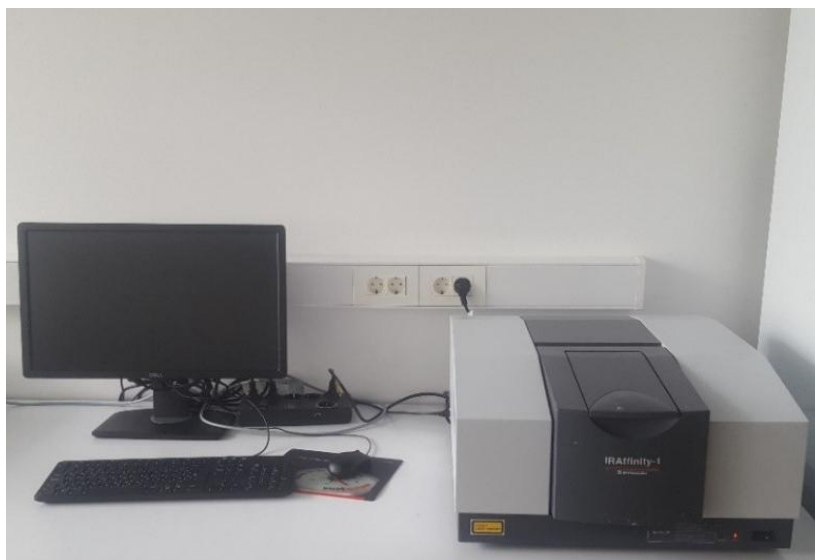
Slika 2.7. FTIR IRAffinity-1 Shimadzu
