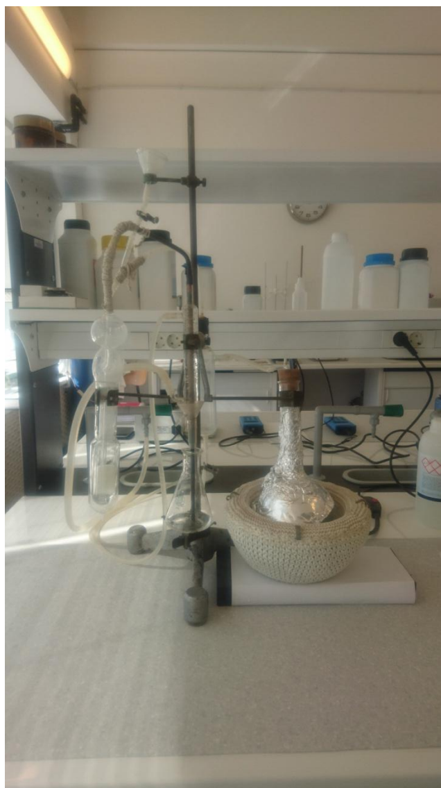
Slika 2.8. Aparatura za mikrodestilaciju po Kjeldahlu
