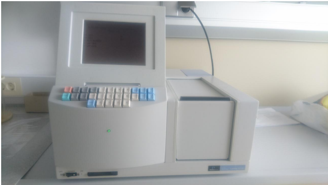
Slika 2.5. Spektrofotometar Perkin Elmer Lambda EZ 201
