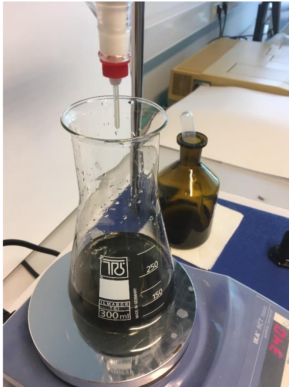
Slika 2.7. Standardizacija tiosulfata jodatom - prije završne točke titracije
