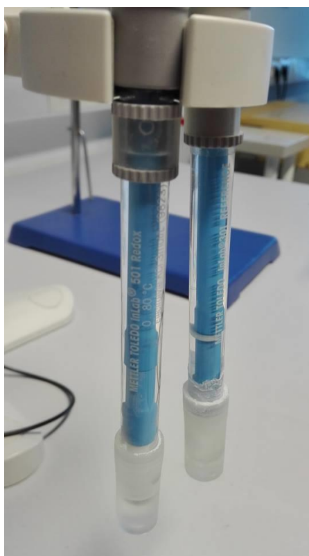
Slika 2.4. Redoks elektroda i referentna Ag/AgCl elektroda
