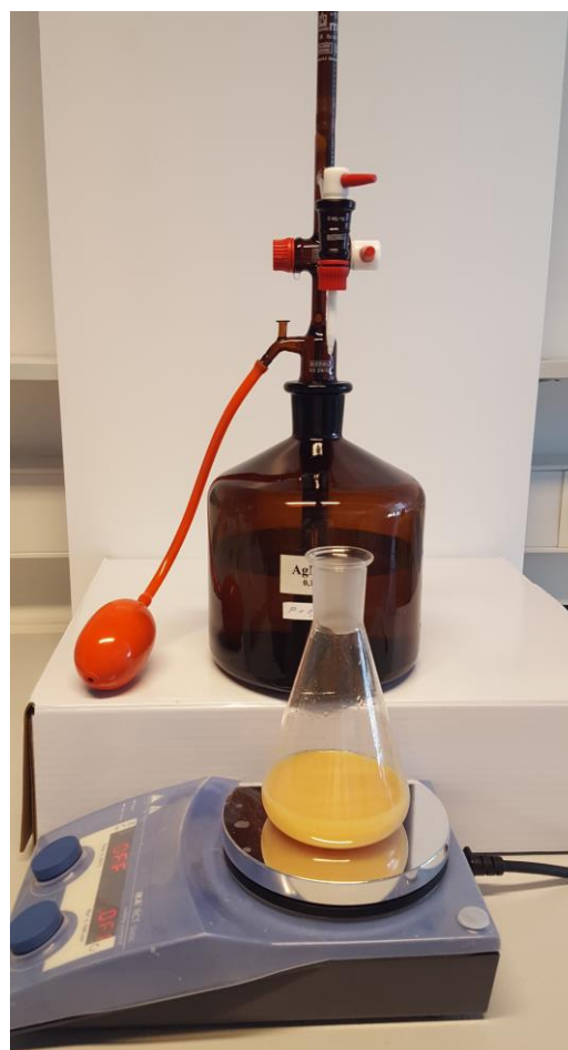
Slika 3-4 Boja nakon točke ekvivalencije
