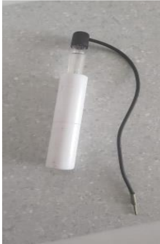
Slika 2.3. Tijelo za elektrodu s unutrašnjom elektrodom
