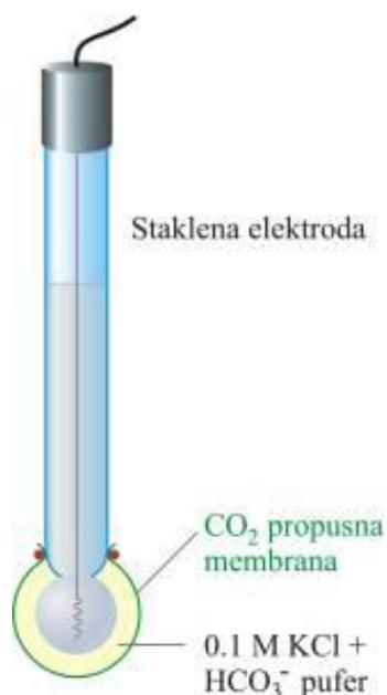
**Slika 10.** Prikaz elektrode za plinove<sup>6</sup>
