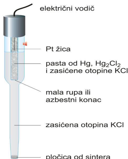
Slika 4. Zasićena kalomelova elektroda<sup>6</sup>
