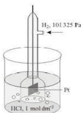
**Slika 3.** Standardna vodikova elektroda<sup>6</sup>
