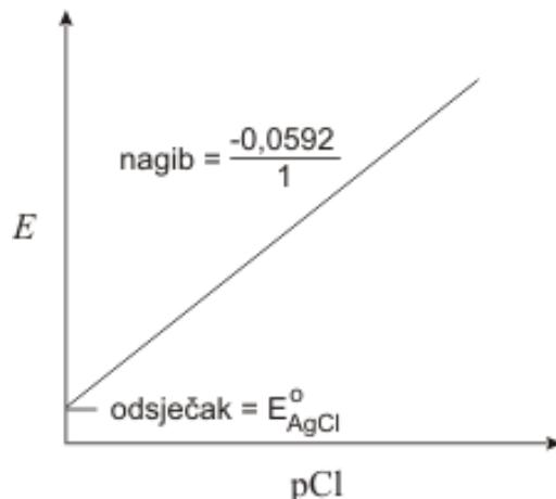
**Slika 7.** Linearna ovisnost koncentracije kloridnih iona o potencijalu elektrode II. reda<sup>3</sup>
