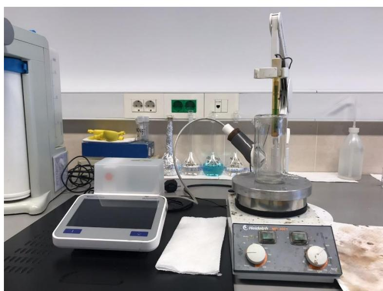
Slika 11. Prikaz sustava za potenciometrijsko mjerjenje
