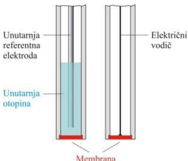
**Slika 8.** Izgled elektrode s kristalnom membranom<sup>6</sup>
