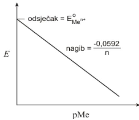
**Slika 6.** Linearna ovisnost koncentracije metalnih iona o potencijalu elektrode I. reda<sup>3</sup>
