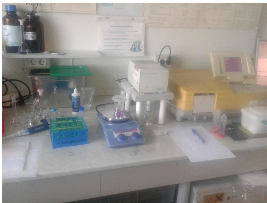
Slika 14. Sustav za provođenje kinetičkih spektrofotometrijskih mjerenja.
