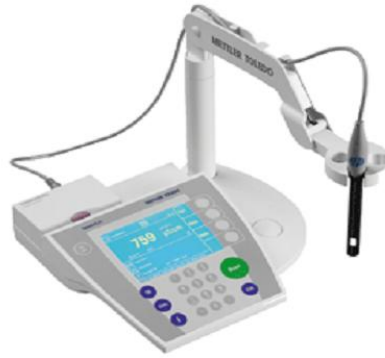
Slika 15. Milivoltmetar Mettler Toledo SevenMulti sa staklenom elektrodom.
