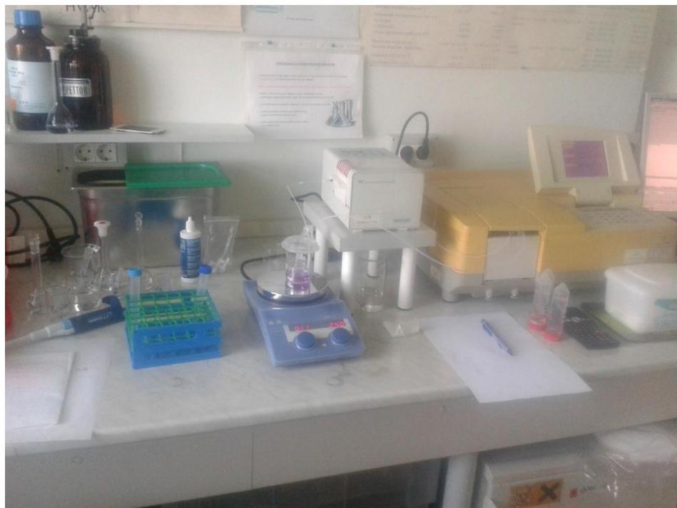
Slika 14. Sustav za provođenje kinetičkih spektrofotometrijskih mjerena.
