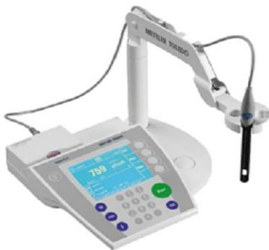
Slika 15. Milivoltmetar Mettler Toledo SevenMulti sa staklenom elektrodom.
