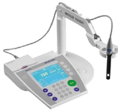
Slika 15. Milivoltmetar Mettler Toledo SevenMulti sa staklenom elektrodom.
