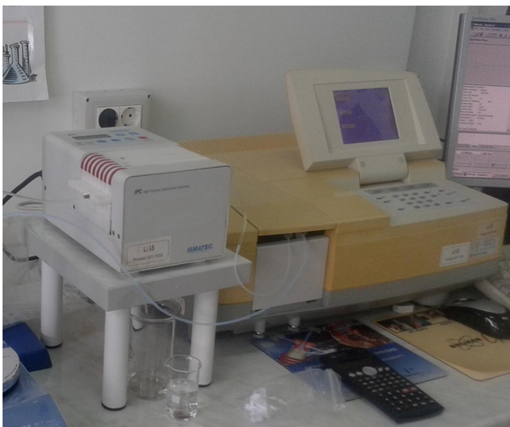
Slika 13 . Spektrofotometar za ultraljubičasto i vidljivo područje Shimadzu UV-1601.
