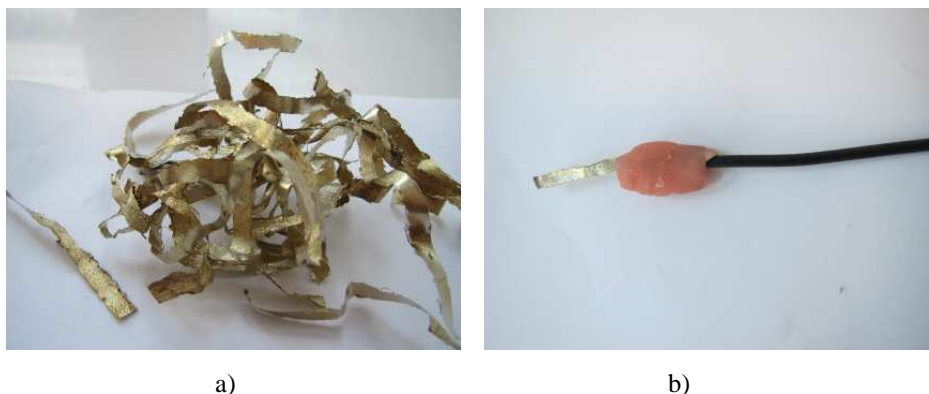
Slika 12. a) Traka legure dobivena postupkom brzog hlađenja; b) pripremljena elektroda za elektrokemijska mjerenja
