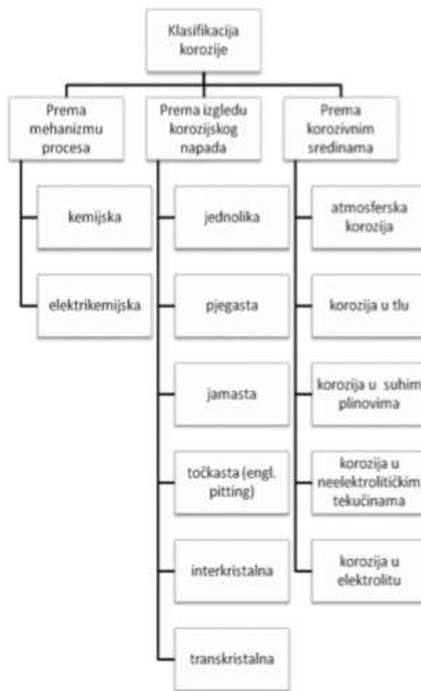
Slika 8. Klasifikacija korozijskih procesa 1
