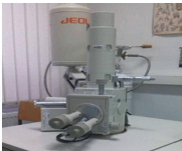
Slika 18. Pretražni elektronski mikroskop JEOL JSM-5610
