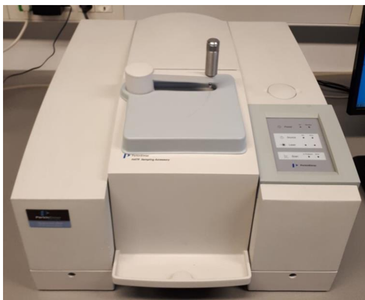
Slika 11. FT-IR spektrometar Spectrum One (Perkin–Elmer) s dodatkom za snimanje HATR tehnikom
