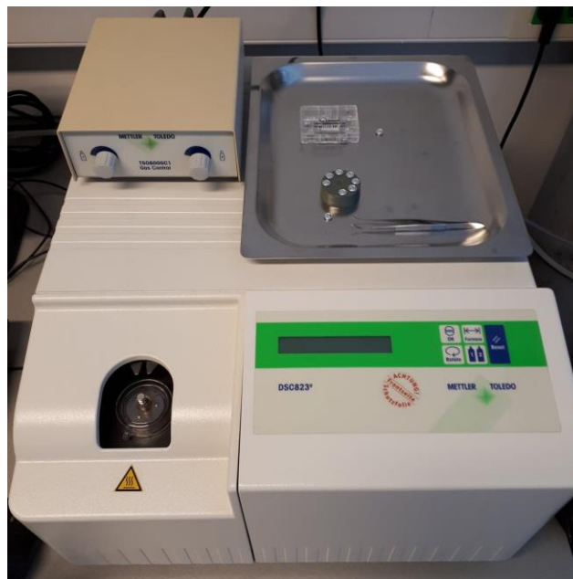
Slika 10. Diferencijalni pretražni kalorimetar DSC 823 e (Mettler Toledo)
