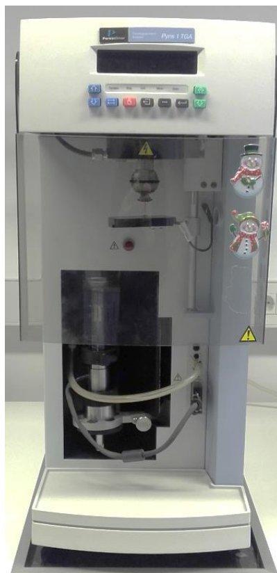
Slika 5. Aparatura za termogravimetrijsku analizu Pyris 1 TGA (Perkin-Elmer)
