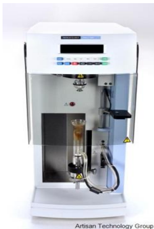
Slika 23. Aparatura za termogravimetrijsku analizu Perkin-Elmer Pyris 1 TGA 43
