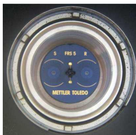
Slika 18. a) Diferencijalni pretražni kalorimetar DSC 823 e (Mettler Toledo, Švicarska) i b) mjerno osjetilo
