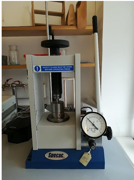
Slika 16. Hidraulička preša Specac za prešanje uzoraka i pravljenje pastila
