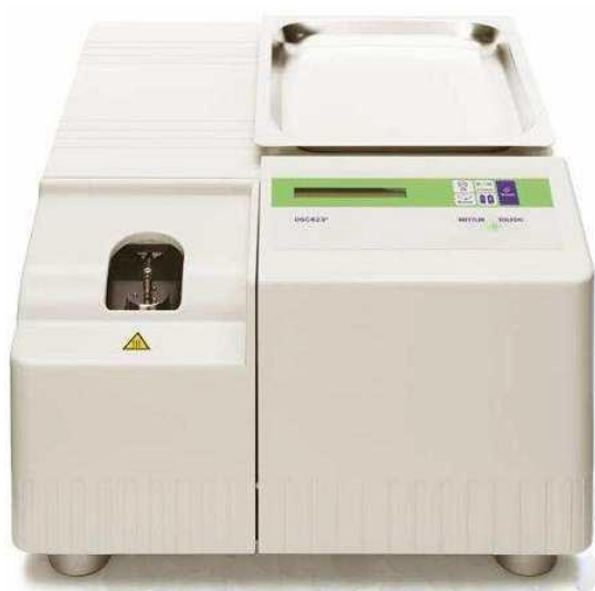
Slika 18. a) Diferencijalni pretražni kalorimetar DSC 823 e (Mettler Toledo, Švicarska) i b) mjerno osjetilo
