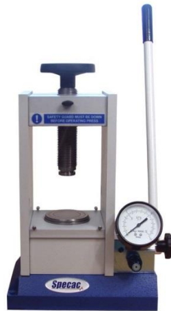
Slika 16. Preša za izradu pastila (Specac)
