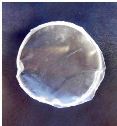
Slika 15. Folija PEO/fenil hib-POSS dobivena metodom iz otopine
