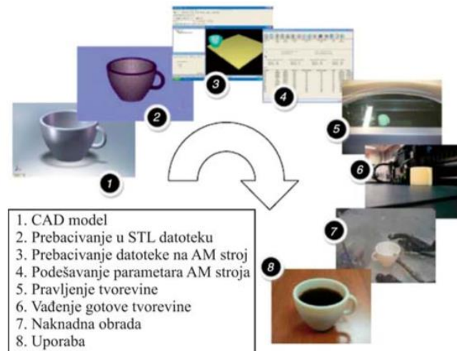
Slika 9. Faze AM proizvodnje 18
