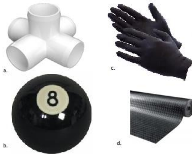
Slika 3. Primjer polimernih materijala: a. PVC (plastomer) 4 , b. Biljarska kugla – od fenol-formaldehidne smole (duromer) 5 , c. Nitrilne rukavice (elastomer) 6 , d. Guma (umreženi elastomer) 7
