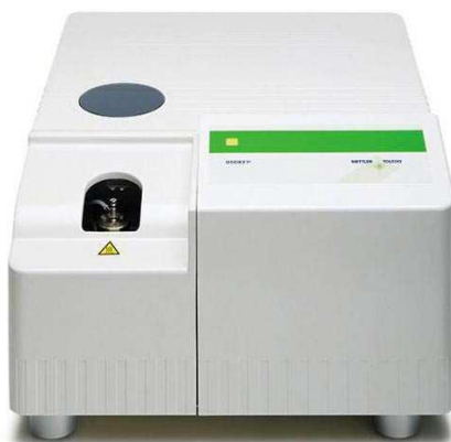
Slika 2.6. Diferencijalni pretražni kalorimetar Mettler Toledo DSC823e
