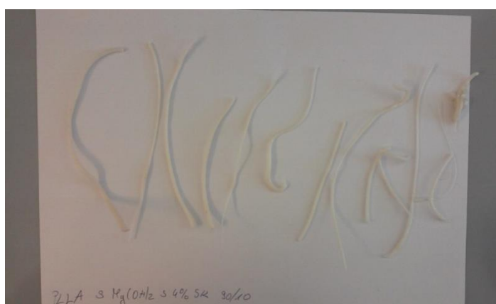
Slika 2.4. PLLA/Mg(OH) 2 kompozit prije postupka ekstrudiranja
