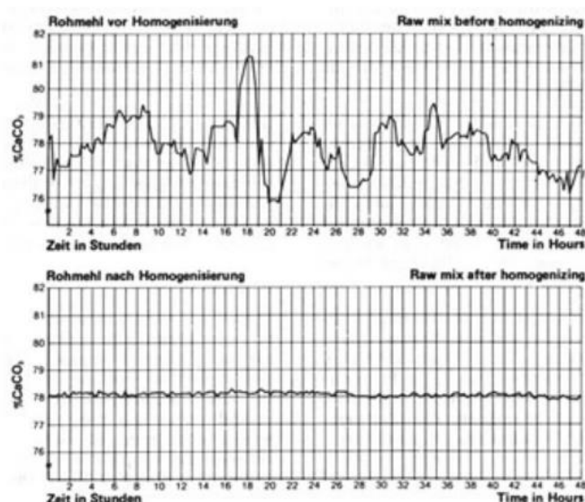
Slika 5. Varijacija CaCO 3 prije i poslije homogenizacije [7]
