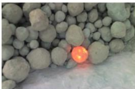
Slika 17. Portland cementni klinker [4]
