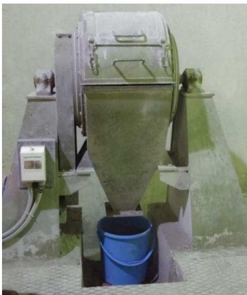
Slika 6. Prikaz poluindustrijskog horizontalnog mlina s čeličnim kuglama [13]
