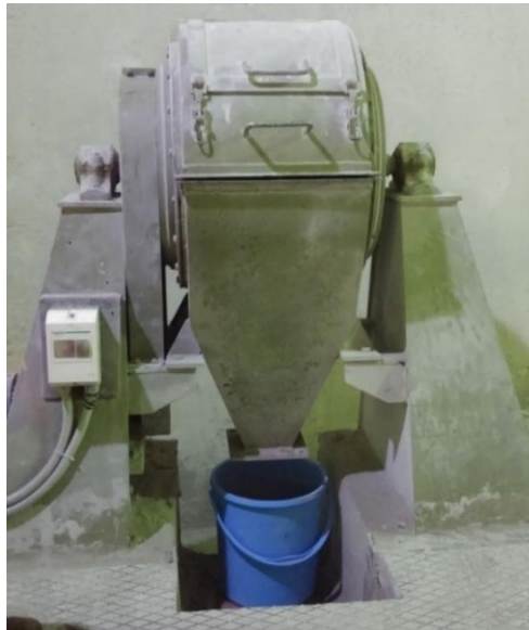
Slika 6. Prikaz poluindustrijskog horizontalnog mlina s čeličnim kuglama [13]
