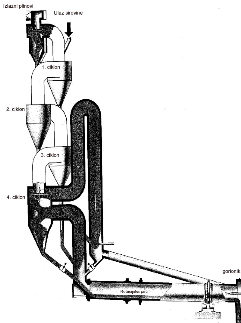
**Slika 5.** Shematski prikaz uređaja za pečenje cementnog klinkera s višestupanjskim predgrijačem, predkalciniratorom, rotacijskom peći i hladnjakom klinkera. [8]
