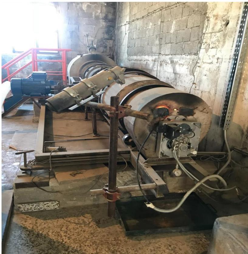
**Slika 22.** Dizalica goriva i rotacijska peć, frontalni prikaz.
