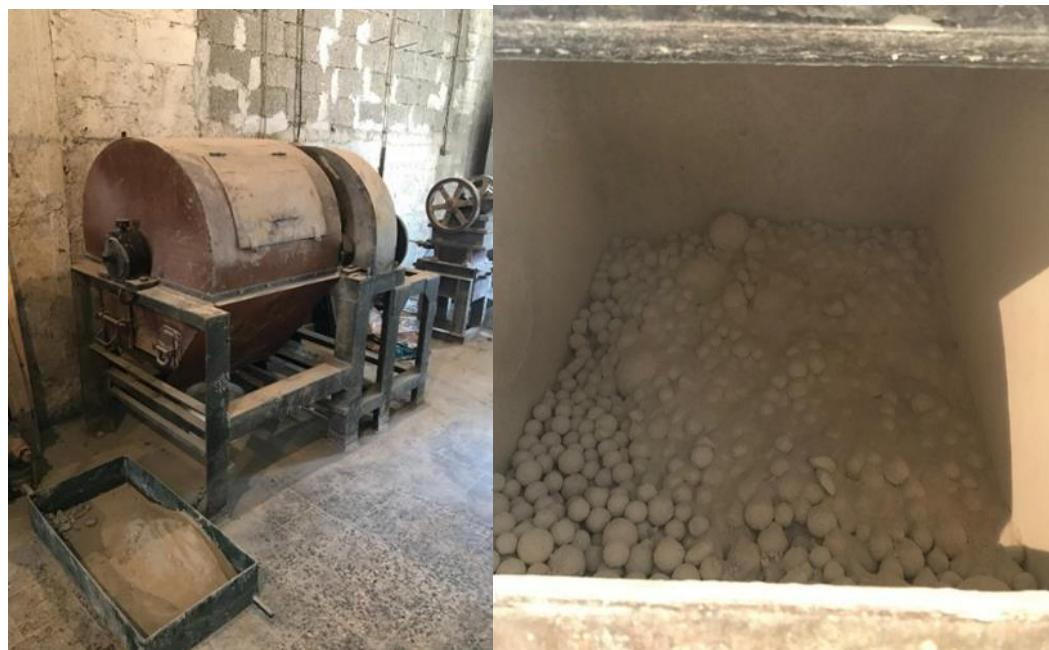
**Slika 11.** Horizontalni kuglični mlin (a), punjenje mлина s čeličnim kuglama(b)
