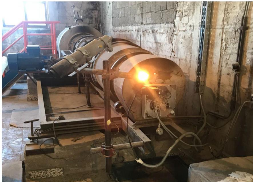
**Slika 13.** Rotacijska peć za sintezu cementnog klinkera
