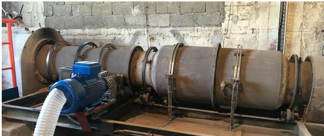
**Slika 21.** Poluindustrijska rotacijska peć, bočni prikaz.
