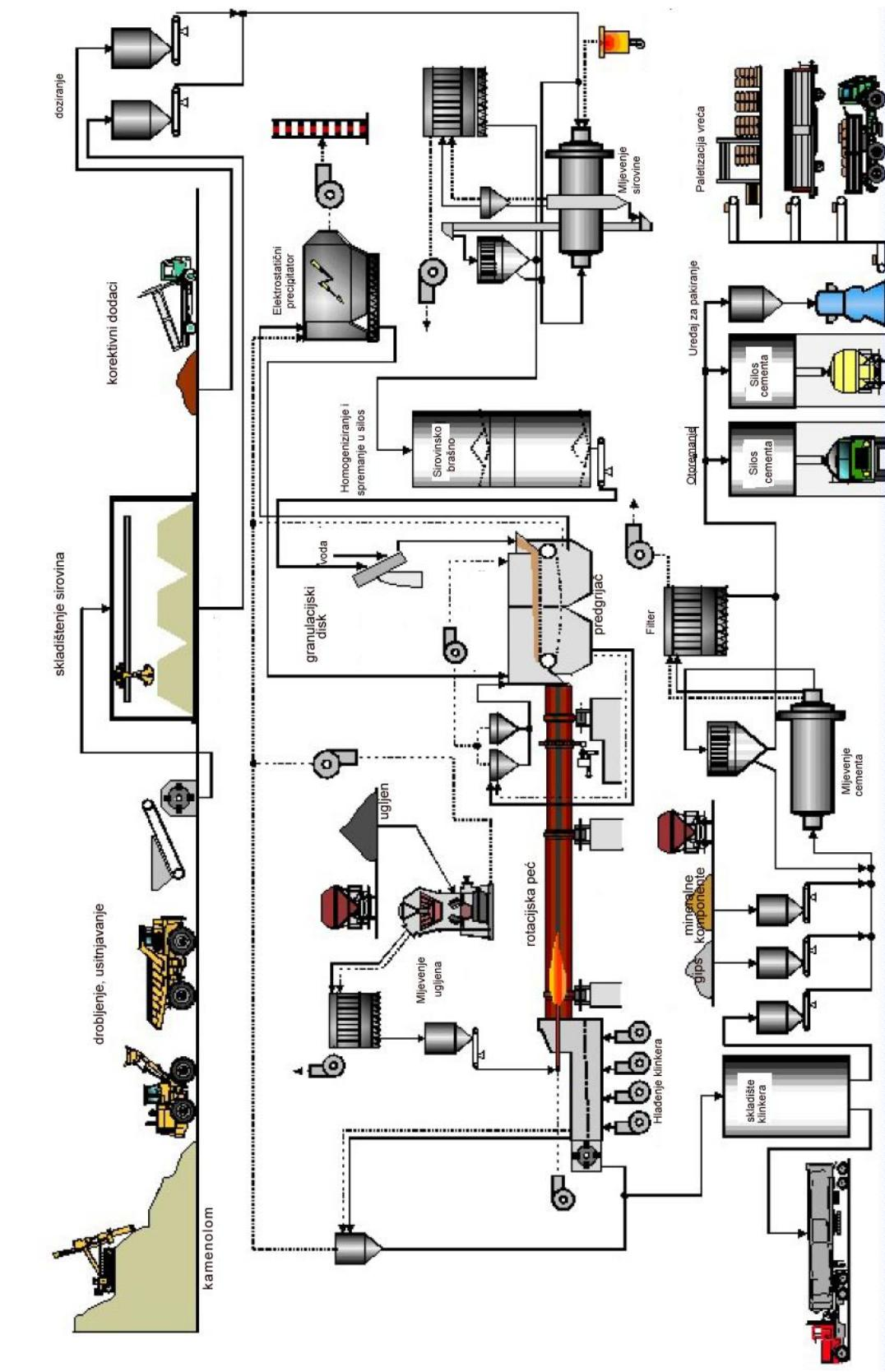
Slika 4. Shematski prikaz proizvodnje cementa polusuhim postupkom. [8]
