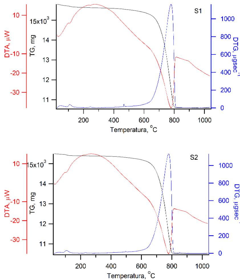
**Slika 20.** TG/DTG-DTA snimak uzorka sirovine S1 i S2.
