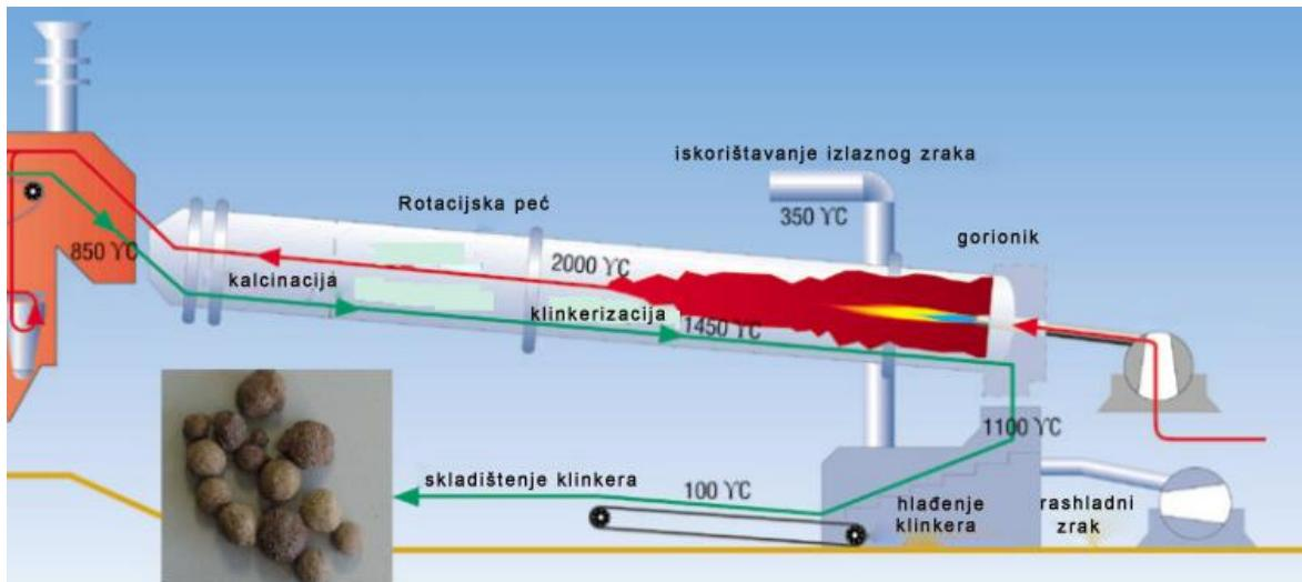
**Slika 3.** Rotacijska peć za proizvodnju klinkera portland cementa. [7]
