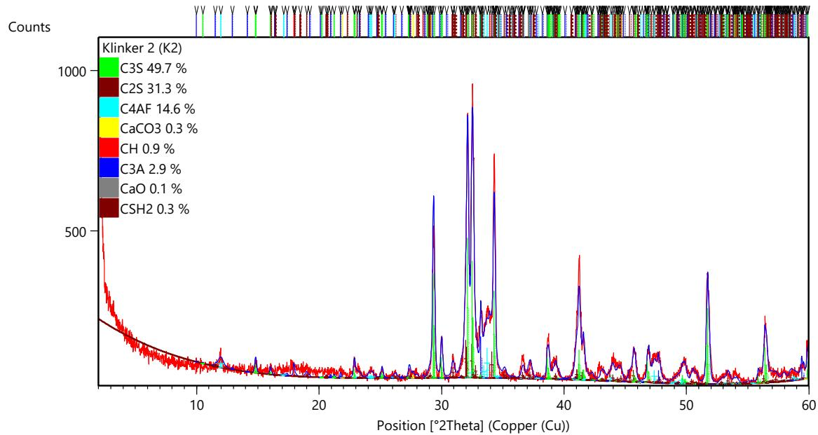
**Slika 24.** Rezultati primjene Rietveld metode kvantificiranja pojedinih mineralnih vrsta koje su prisutne u uzorku Klinker 2 (K2)
