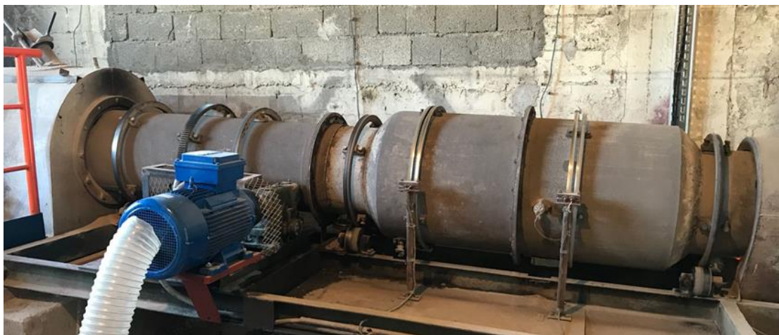
Slika 21. Poluindustrijska rotacijska peć, bočni prikaz.
