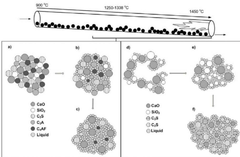
**Slika 9.** Rastaljena i granulirana forma. a) Klinker sadrži kristale sustava četiri oksida sve do temperature između 1220-1338 °C. b) Početak taljenja, C<sub>3</sub>A, C<sub>4</sub>AF, i SiO<sub>2</sub> se tale. c) C<sub>2</sub>S se djemomito tali ukoliko je SiO<sub>2</sub> cijeli potrošen. d) CaO i SiO<sub>2</sub> su okružene talinom i formom poroznih granula. e) Gušće granule su formirane, tijekom grupiranja malih čestica u granule.
