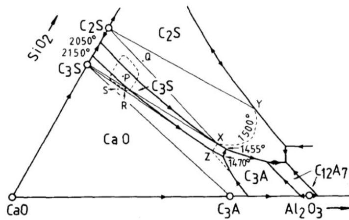
**Slika 7.** Dio sustava  $\text{CaO}\text{-}\text{Al}_2\text{O}_3\text{-}\text{SiO}_2$ , ilustracija formacije portlandskog klinkera.
