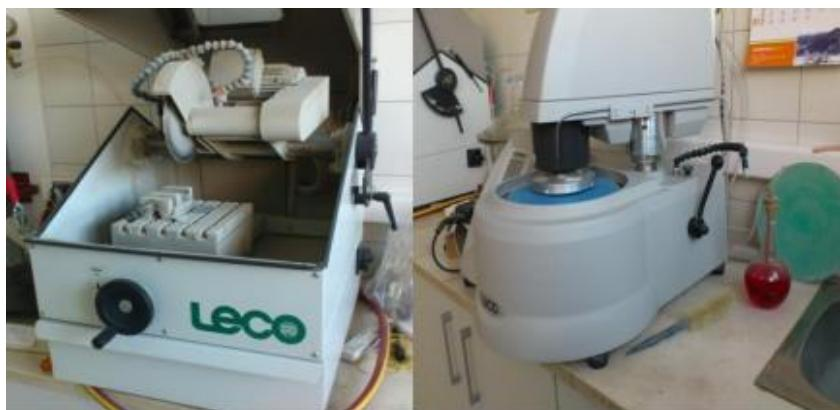
**Slika 16.** Priprema uzorka za mikroskopiju a) rezalica materijala, b)brusilica/polirka uzorka.
