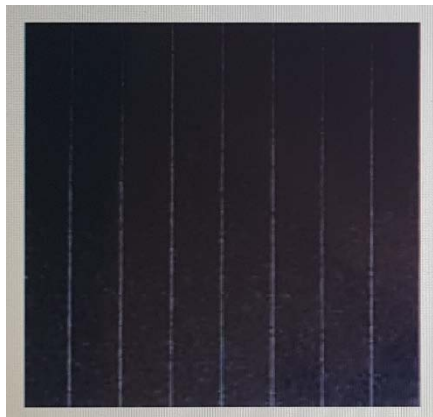
Slika 5. Solarna ćelija na bazi bakar-indij-diselenida (CIS) 4
