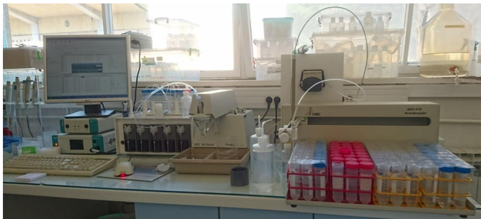
Slika 2.8. \mu Autolab III potencijostat (Metrohm-Autolab)
