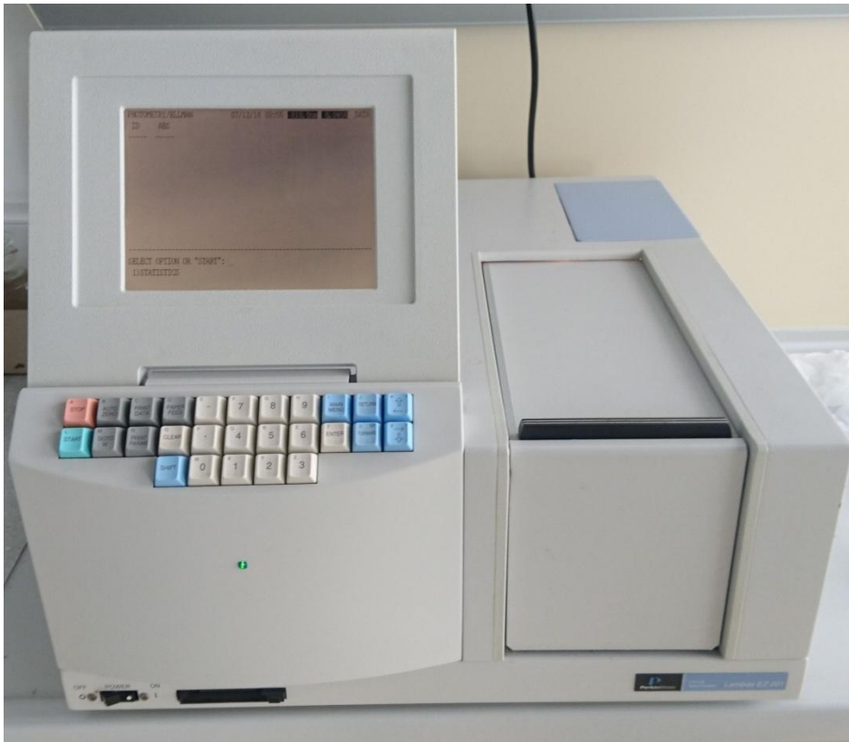
Slika 2.9. Spektrofotometar Perkin Elmer Lambda EZ 201
