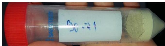
**Slika 2.3.** Uzorak prirodnog zeolita klinoptilolita dimenzija čestica 71-90 µm
