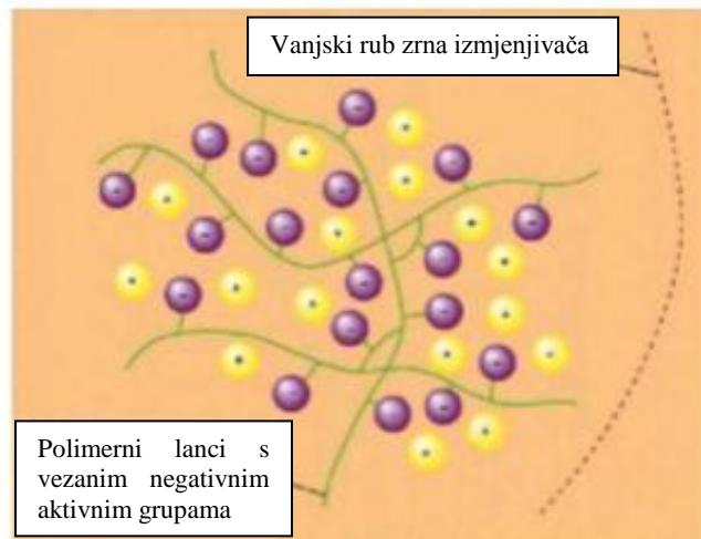
**Slika 1.15.** Shematski prikaz strukture ionskog izmjenjivača<sup>2</sup>
