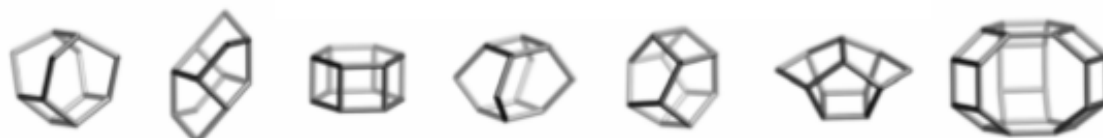
Slika 1.7. Tercijarne strukturne jedinice zeolita 13
