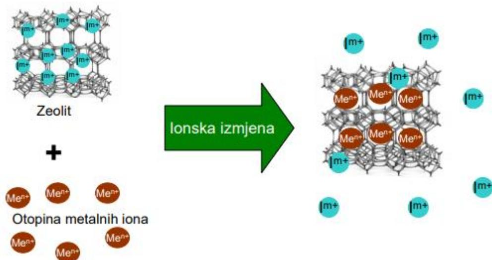
**Slika 1.16.** Prikaz procesa ionske izmjene metalnog iona iz otopine s izmjenjivim kationima iz strukture zeolita<sup>13</sup>
