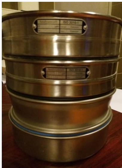
Slika 2.5. Sita s različitim otvorom očica
