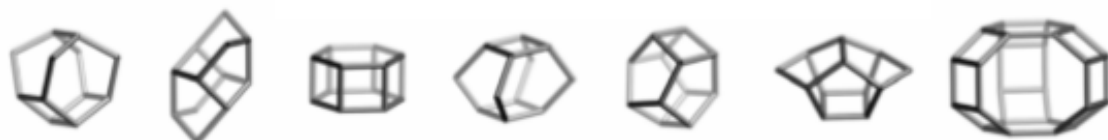
Slika 1.7. Tercijarne strukturne jedinice zeolita 13
