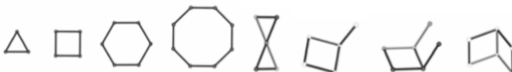
Slika 1.6. Sekundarne strukturne jedinice zeolita 13
