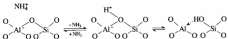
Slika 1.12. Dobivanje H-zeolita<sup>14</sup>
