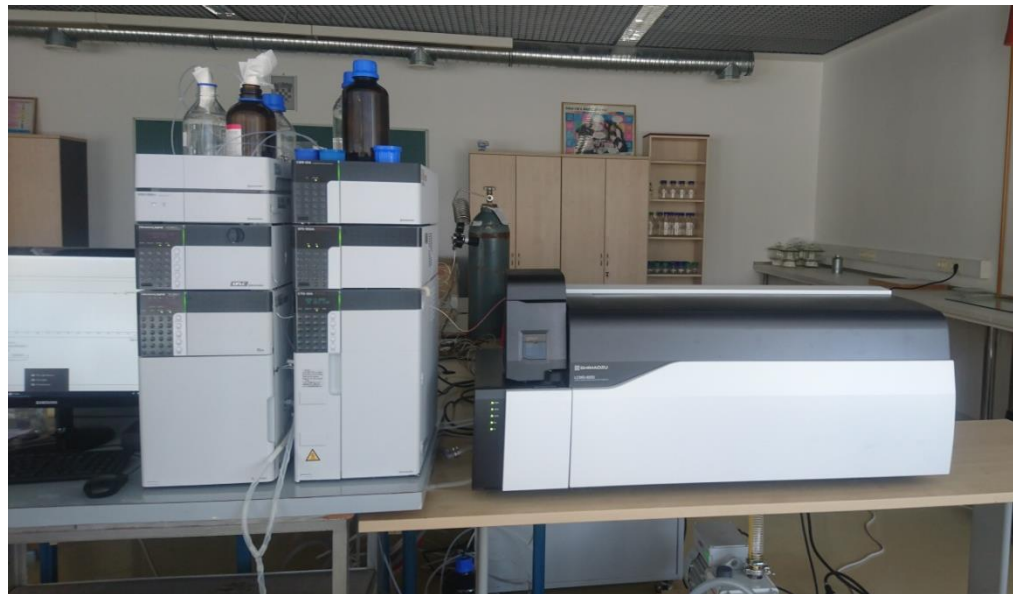
Slika 37. HPLC-DAD-MS/MS uređaj (Shimadzu, Japan).
