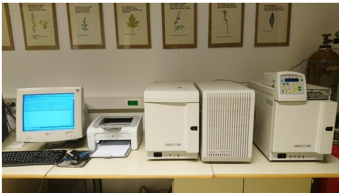
Slika 35. GC-MS uređaj (Varian, USA).
