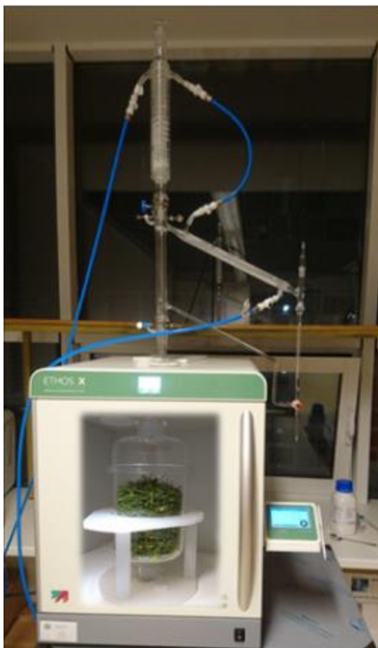
Slika 21. Uređaj za mikrovalnu destilaciju (gornji dio, engl. fragrance ).
