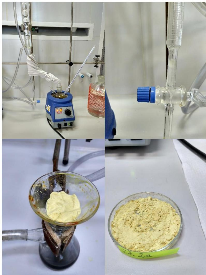
Slika 2.7. Prikaz postupka sinteze spoja 4a
