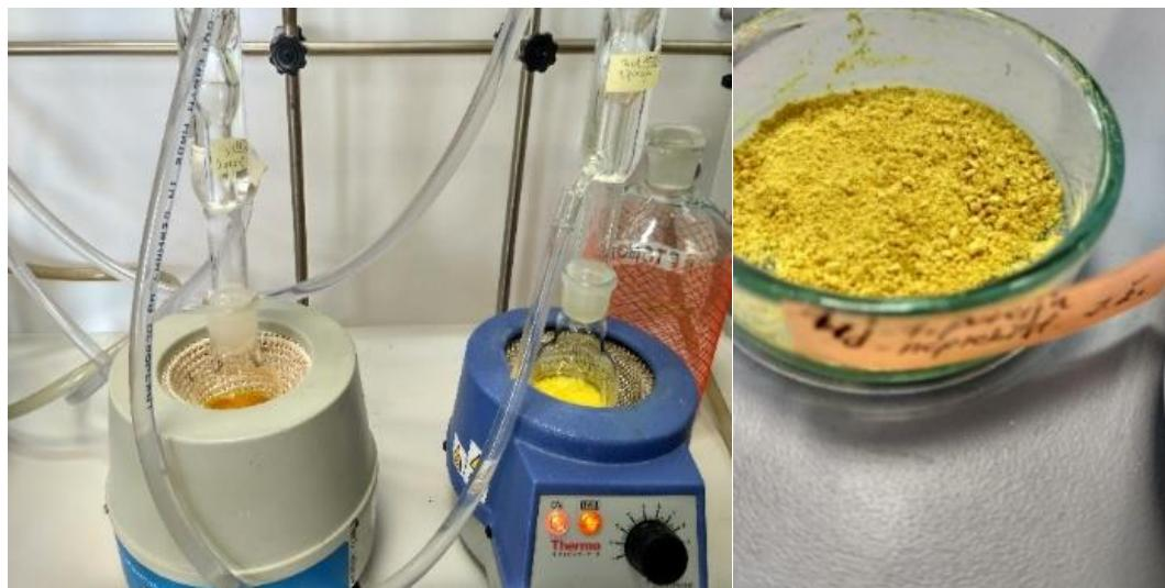
Slika 2.17. Prikaz postupka sinteze spoja 6b
