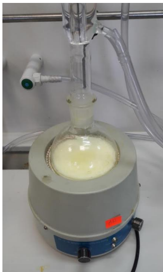
Slika 2.32. Prekrystalizacija iz metanola.
