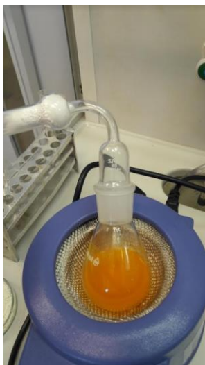
Slika 2.37. Reakcijska smjesa na magnetskoj miješalici.
