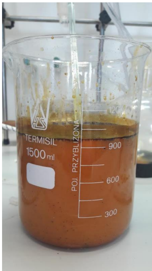
Slika 2.11. Led, destilirana voda, reakcijska smjesa i HCl (još nije pH=2).
