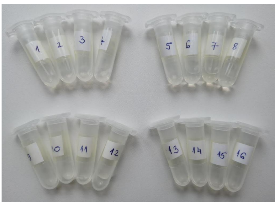
Slika 2.48. Uzorci nakon probave i desulfatacije.
