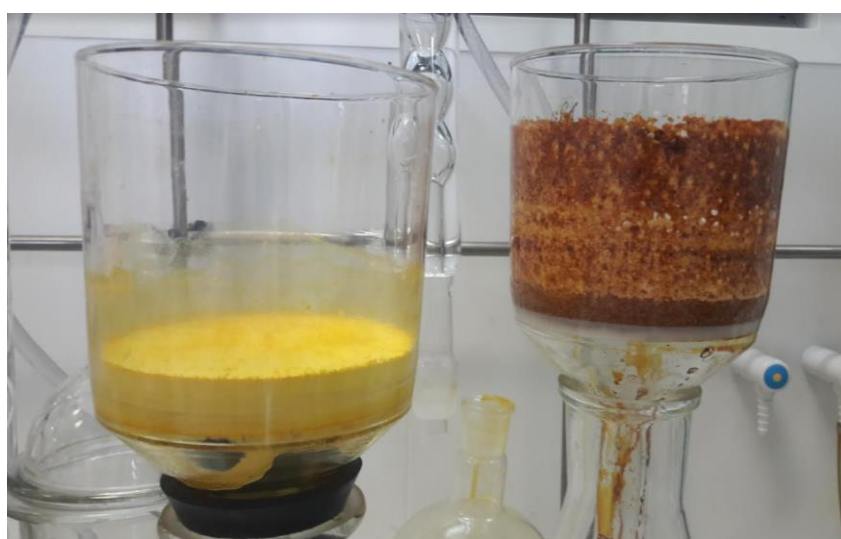
Slika 2.14. Usporedba taloga prije i poslije pročišćavanja etanolom.
