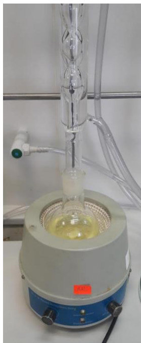
Slika 2.28. Reakcija međuprodukta (4) i hidrazina na refluksu
