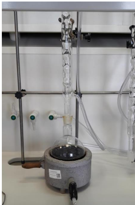
Slika 2.10. Dodatno refluksiranje smjese tijekom 2,5 h.
