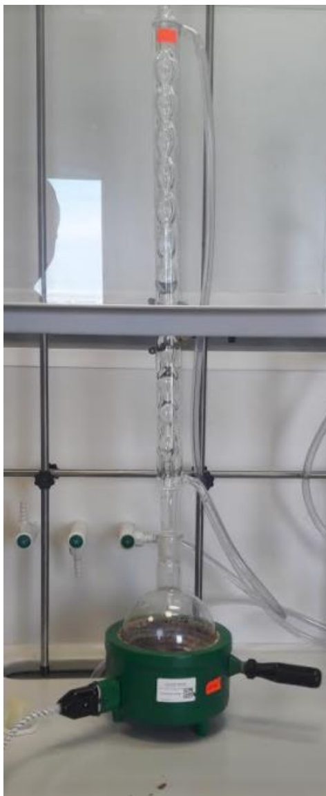
Slika 2.5. Aparatura za refluks.
