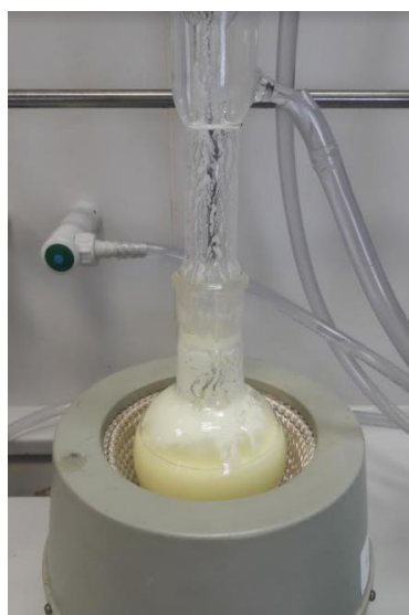
Slika 2.29. Burna reakcija pri previsokoj temperaturi.
