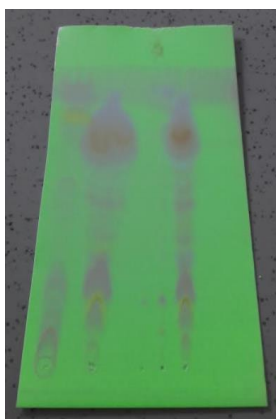
Slika 2.7. TLC pločica - prva kolona čisti dietil 2-metil-6-fenil-piridin-3,4-dikarboksilat, druga i treća sintetizirani spojevi.
