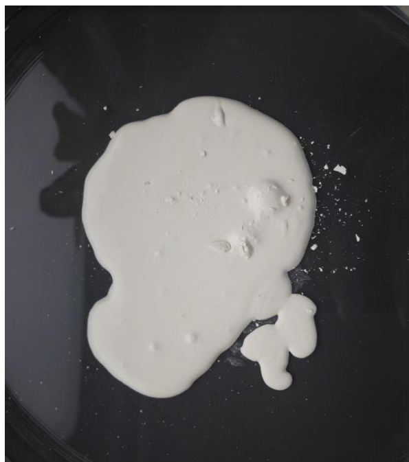
Slika 2.19. Vlažni talog pročišćene 2-metil-6-fenil-piridin-3,4-dikarboksilne kiseline.
