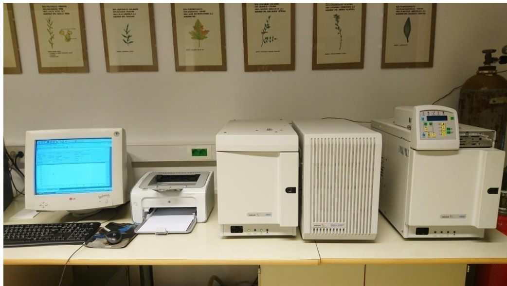
Slika 2.1. GC-MS uređaj (Varian, USA).
