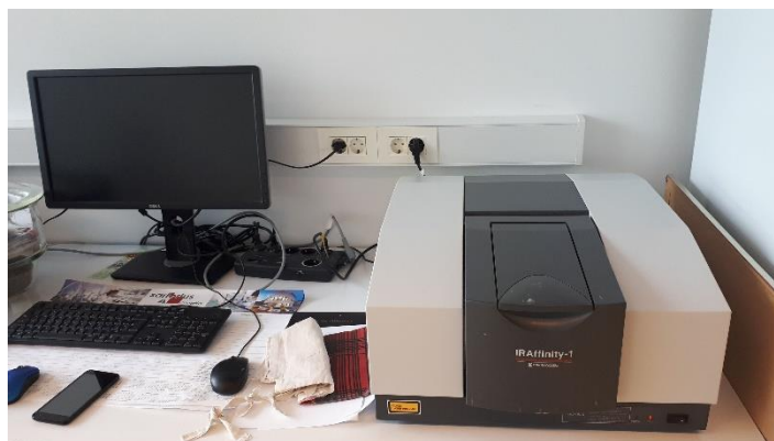
Slika 4.14. Spektrometar s Fourierovom transformacijom.
