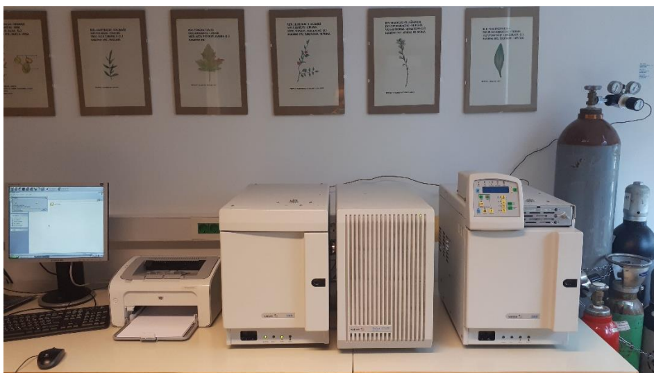
Slika 4.16. Uređaj za plinsku kromatografiju s masenim spektrometrom.
