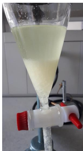
Slika 4.7. Ekstrakcija s diklormetanom.
