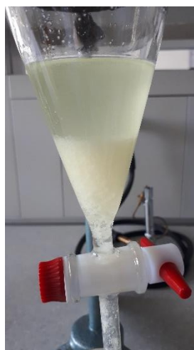
Slika 4.7. Ekstrakcija s diklormetanom.
