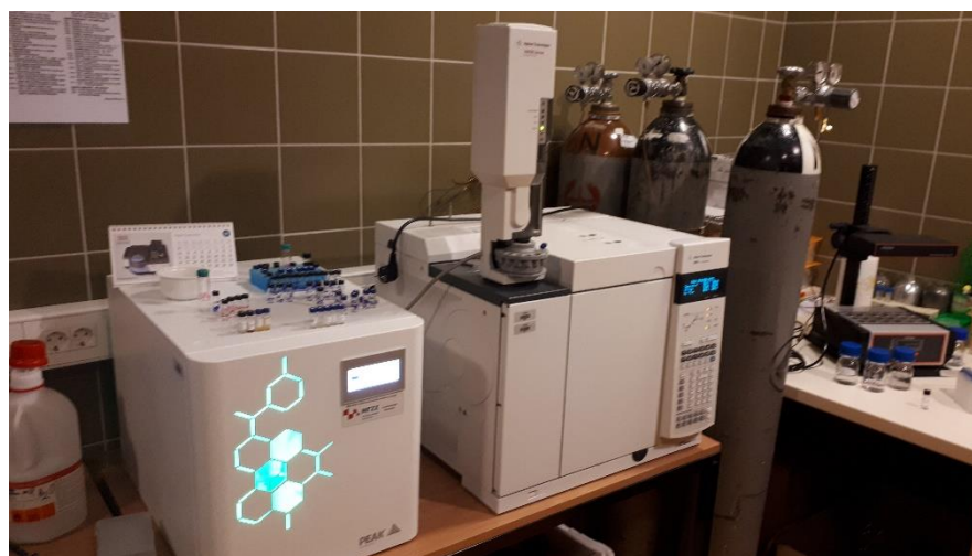
Slika 4.15. Uređaj za plinsku kromatografiju s plameno ionizacijskim detektorom.
