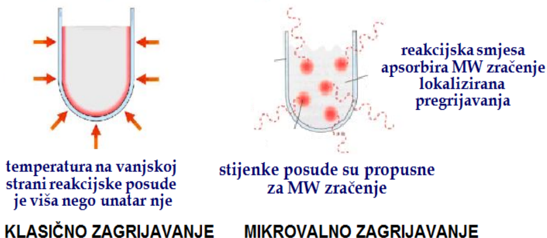
Slika 16. Usporedba klasičnog i mikrovalnog zagrijavanja 11
