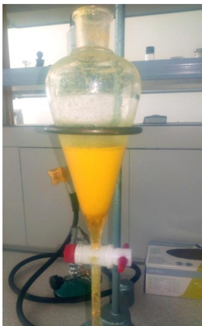
Slika 36. Ekstrakcija uzorka (mikrovalna sinteza pri 40 W)
