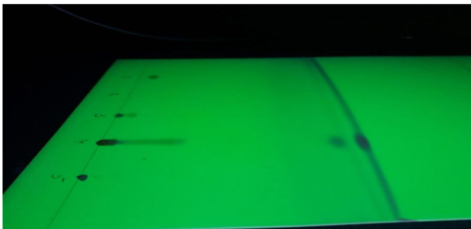
Slika 27. Tankoslojna kromatografija nakon klasične sinteze
