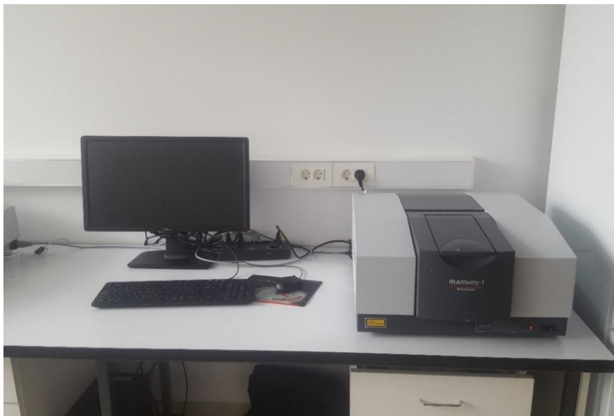
Slika 40. Spektrometar s Fourierovom transformacijom
