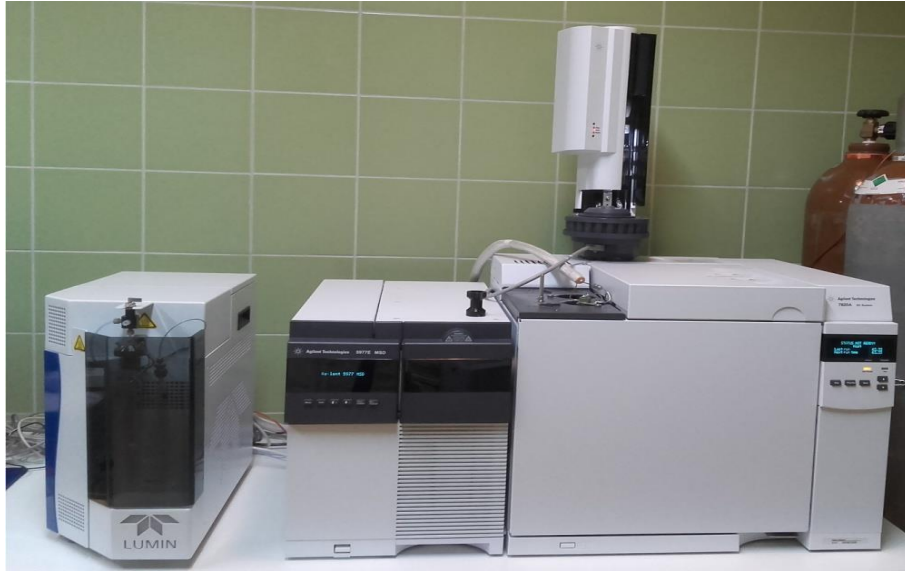
Slika 9. Vezani sustav plinska kromatografija-spektrometrija masa (GC-MS)
