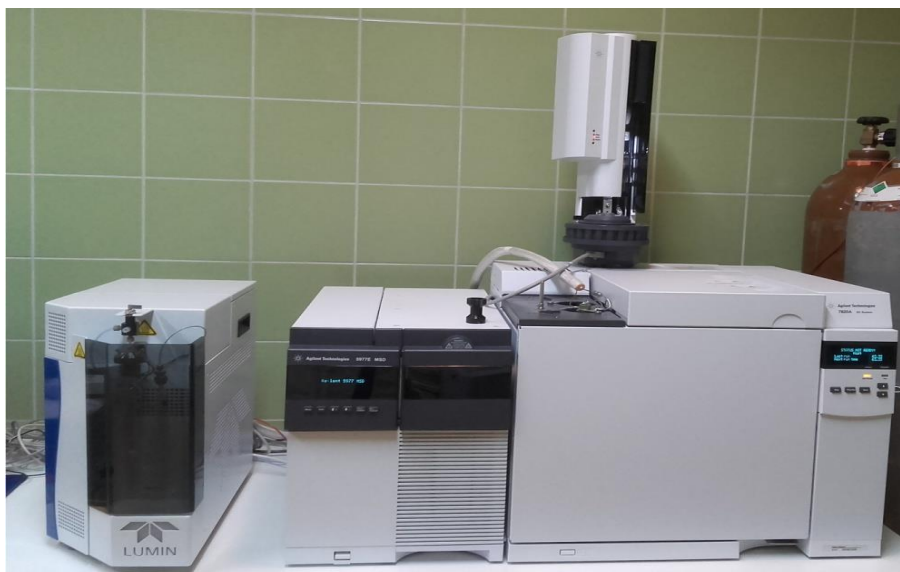
Slika 9. Vezani sustav plinska kromatografija-spektrometrija masa (GC-MS)
