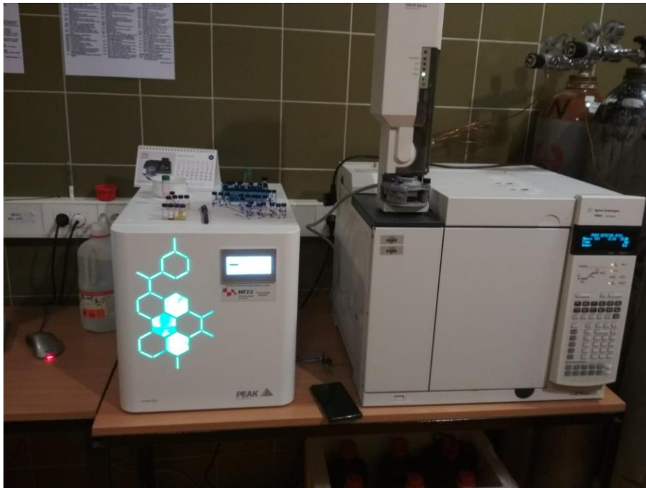
Slika 8. Prikaz GC-FID uređaja Agilent 7890A
