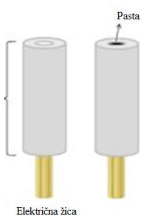
Slika 4 - Osnovna konstrukcija elektrode od ugljikove paste, električna žica za kontakt, pasta i cijev [19]
