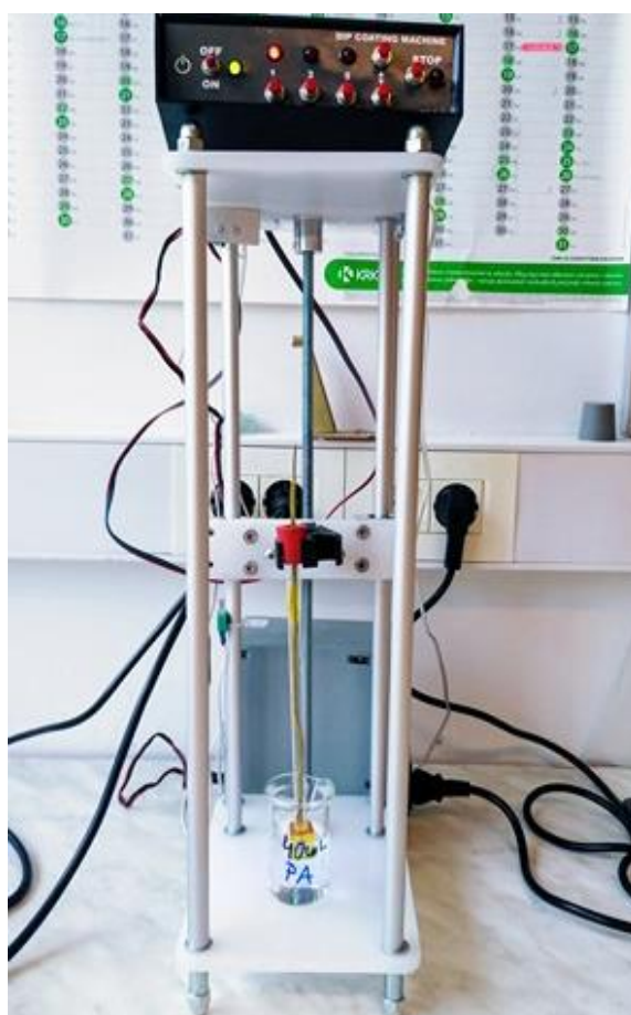
Slika 16. Prikaz nanošenja aditiva dip- coating metodom.
