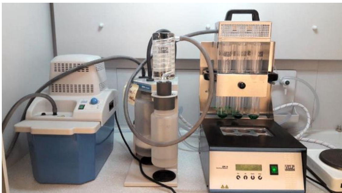
Slika 2.7. Aparatura za određivanje dušika po Kjeldahlu
