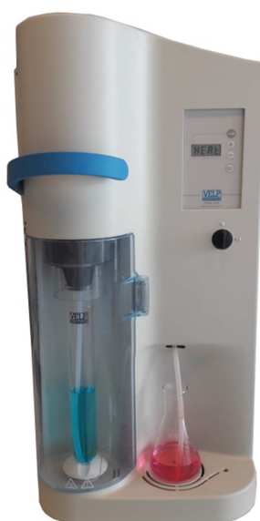
Slika 2.9. Uređaj za destilaciju uzorka.
