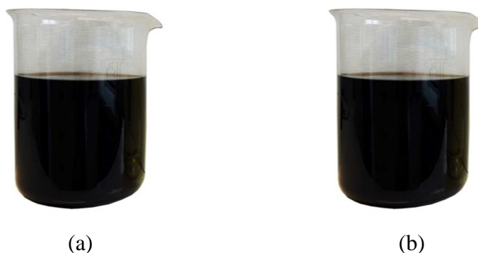
Slika 2.13. Uzorak procjede vode: (a) prije obrade i (b) nakon aeracije.
