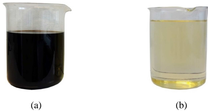
Slika 2.14. Uzorak procjede vode: (a) prije obrade i (b) nakon aeracije.
