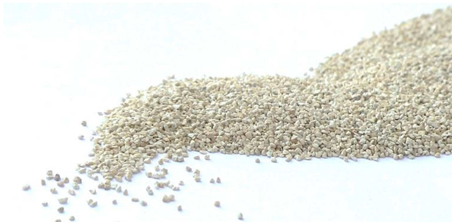
Slika 2.1. Prirodni zeolit klinoptilolit veličine čestica 0,6 - 0,8 mm
