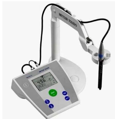
Slika 2.4. Uređaj za mjerenje pH vrijednosti Mettler Toledo
