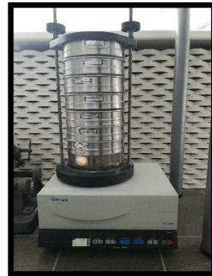
Slika 20. Treskalica sa sitima za prosijavanje
