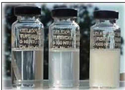
Slika 8. Uzorci vode zamućenja 5, 50 i 500 NTU (od lijeve na desnu stranu). 15
