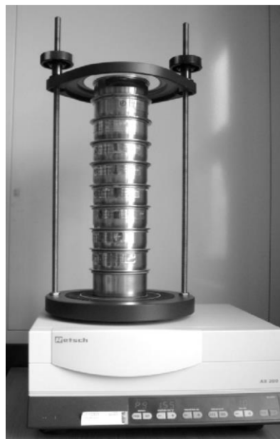
Slika 10. Aparatura za provedbu granulometrijske analize prosijavanjem.
