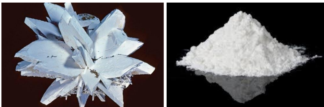
Slika 6. Lijevo: kristal boraksa, desno: boraks u prahu 11 .
