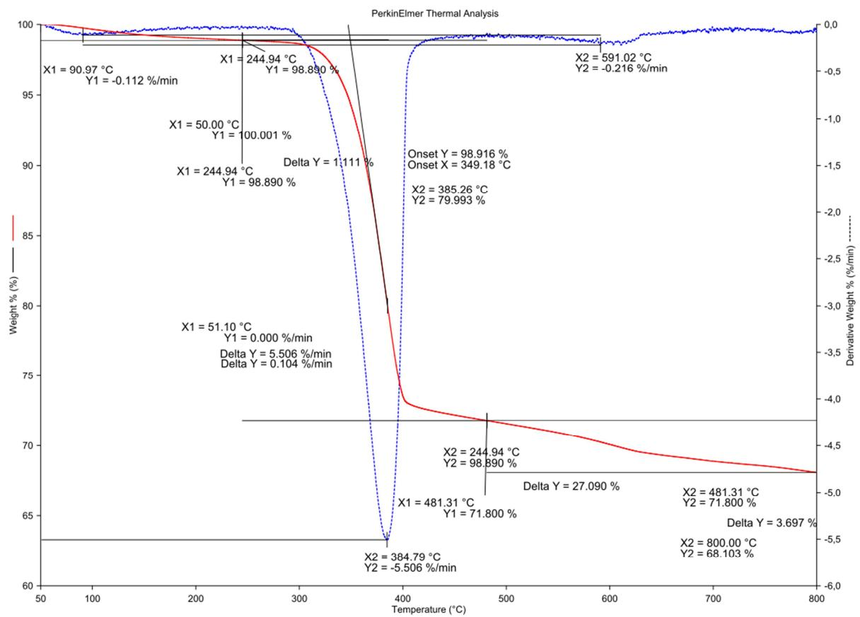
Slika 2.3. TG/DTG analiza uzoraka magnezijeva hidroksida bez primjene ultrazvuka.
