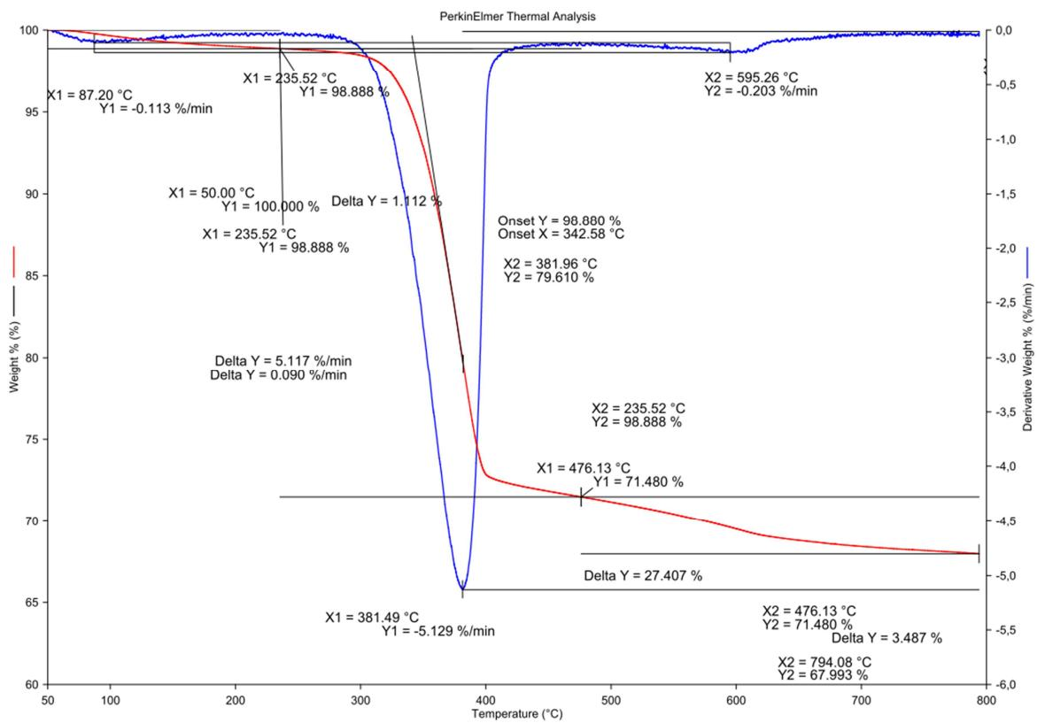
Slika 2.4. TG/DTG analiza uzoraka magnezijeva hidroksida uz primjenu ultrazvuka.
