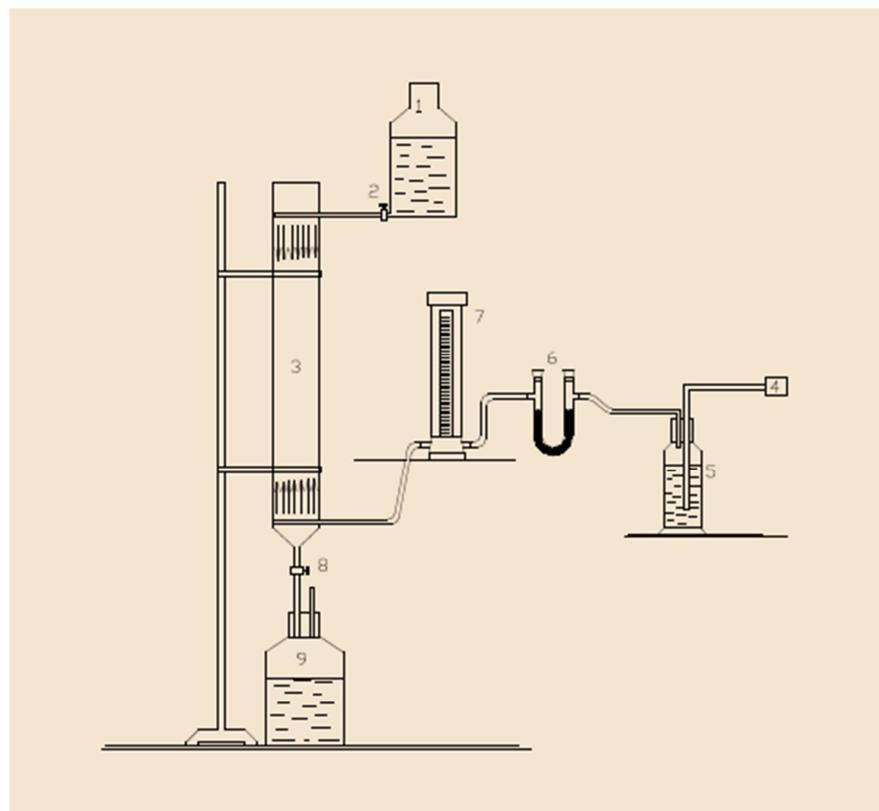
Slika 2.2. Shematski prikaz aparature za desorpciju  $\text{CO}_2$  iz morske vode, 1 – posuda napunjena zakiseljenom morskom vodom, 2 – pipac, 3 – desorpcijski toranj, 4 – crpka, 5 – ispiralica, 6 – U-cijev, 7 – rotametar, 8 – pipac, 9 – posuda s obrađenom morskom vodom
