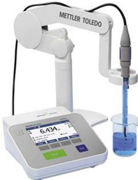
Slika 2.1. Shematski prikaz pH-metra SevenCompact<sup>TM</sup> S220
