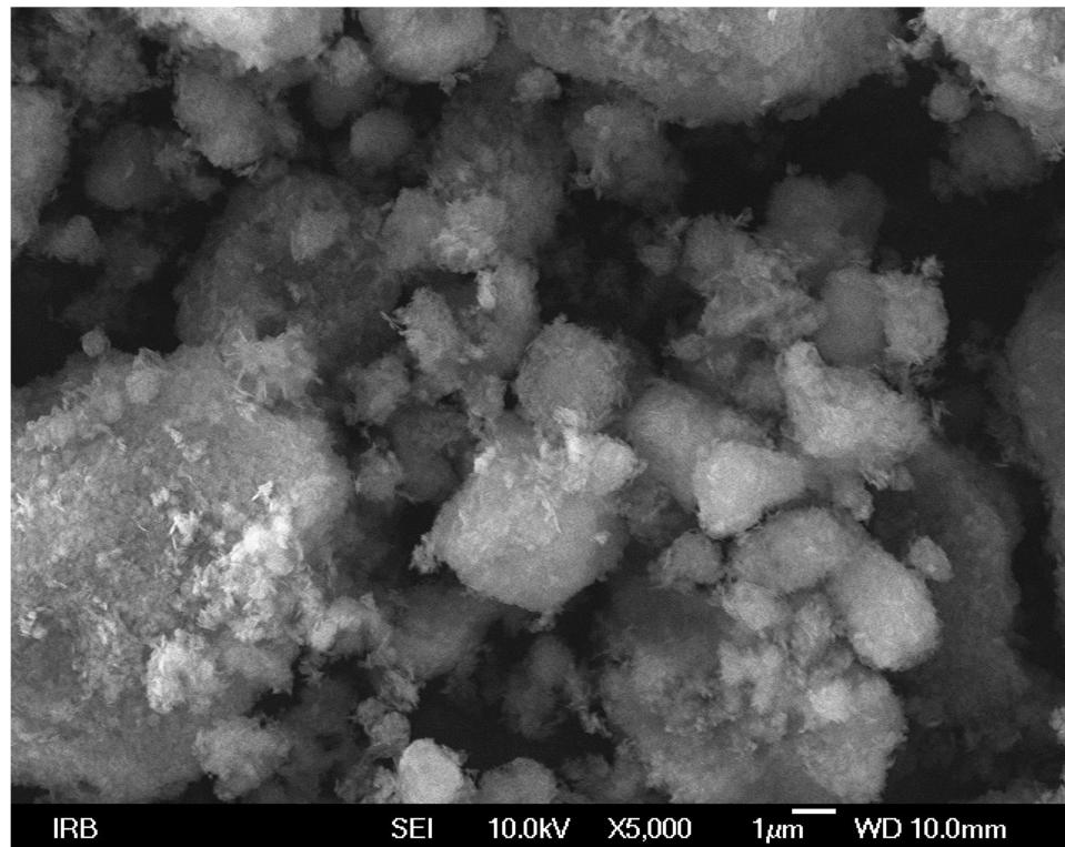
Slika 2.6. SEM snimka uzorka magnezijeva hidroksida (80% tno taloženje) dobivenog iz morske vode bez primjene ultrazvuka, povećanje 5000 x.
