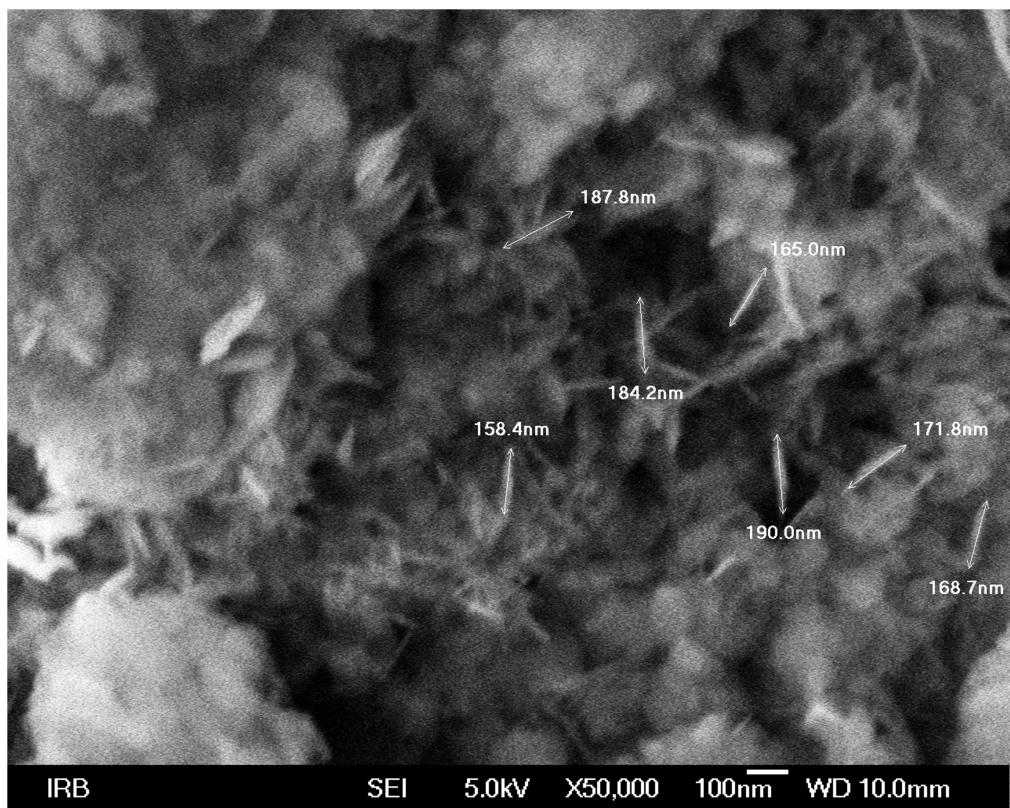
Slika 2.7. SEM snimka uzorka magnezijeva hidroksida (80% tno taloženje) dobivenog iz morske vode bez primjene ultrazvuka, povećanje 50 000 x.
