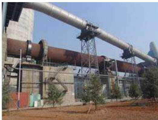
Slika 2. Rotacijska peć u postrojenju za dobivanje cementa 3
